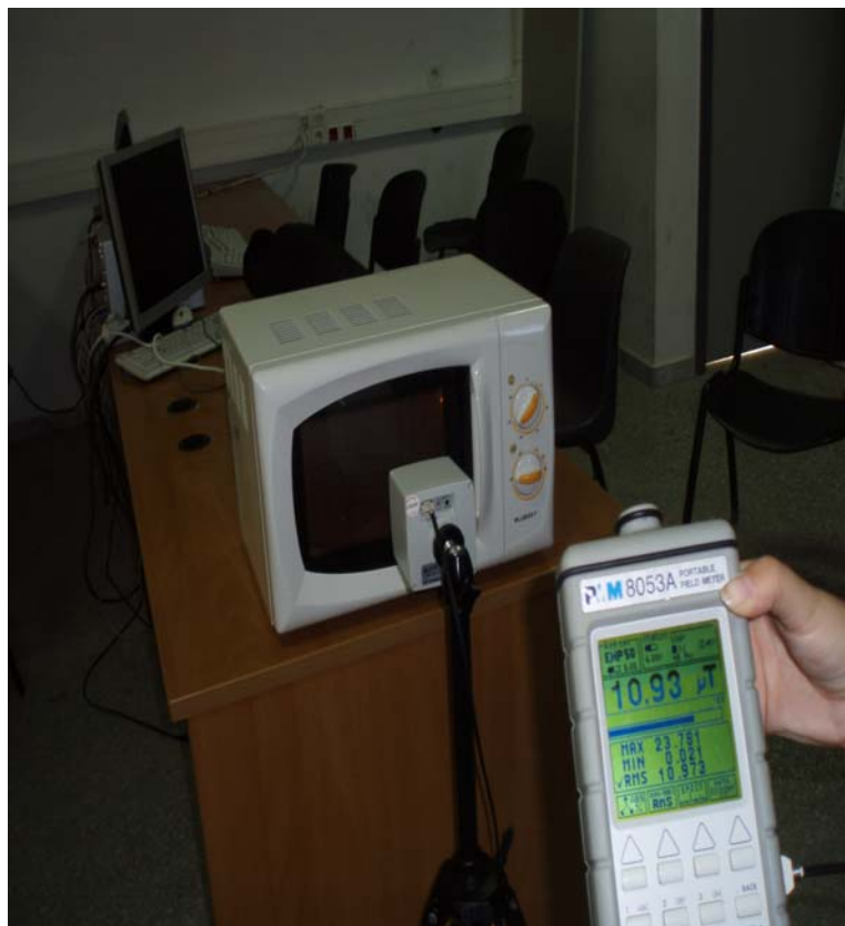
Εικόνα 14: Μέτρηση της ενεργού τιμής (rms) της Μαγνητικής Επαγωγής B του φούρνου μικροκυμάτων με χρήση του αισθητήρα EHP 50C (5Hz -100KHz)
