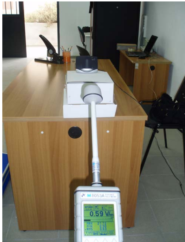
Εικόνα 20: Μέτρηση της ενεργού τιμής (rms) της έντασης E του ηλεκτρικού πεδίου της βάσης του ασύρματου τηλεφώνου με χρήση του αισθητήρα EP300 (100KHz – 3 GHz)
