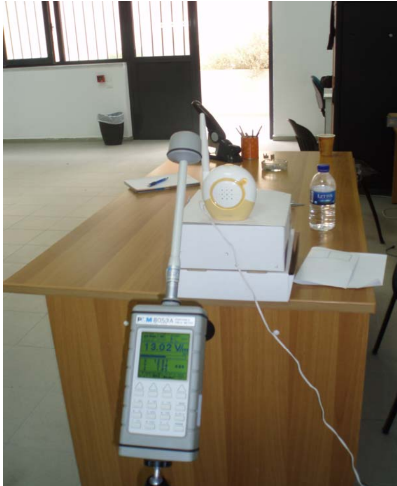
Εικόνα 18: Μέτρηση της ενεργού τιμής (rms) της έντασης E του ηλεκτρικού πεδίου του συστήματος ενδοεπικοινωνίας με χρήση του αισθητήρα EP 44M (0Hz – 800 MHz)
