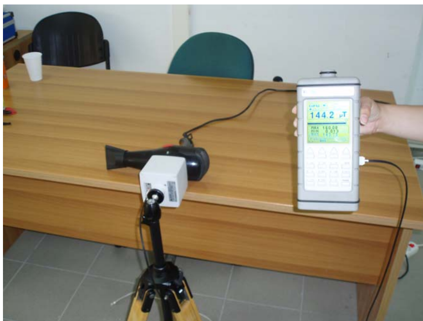
Εικόνα 16: Μέτρηση της ενεργού τιμής (rms) της Μαγνητικής Επαγωγής B του σεσουάρ με χρήση του αισθητήρα EHP50C (5Hz –100KHz)
