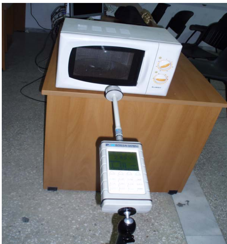
Εικόνα 12: Μέτρηση της ενεργού τιμής (rms) της έντασης E του ηλεκτρικού πεδίου του φούρνου μικροκυμάτων με χρήση του αισθητήρα EP300 (100KHz – 3 GHz)
