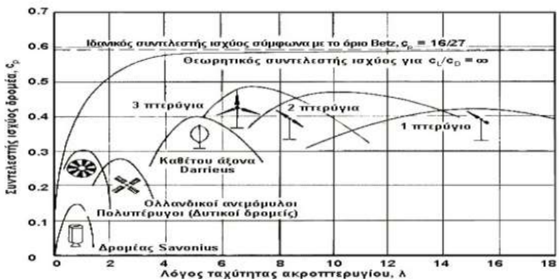
Σχήμα 14 Τυπικά διαγράμματα C_p - \lambda για διάφορες ανεμογεννήτριες [12].
