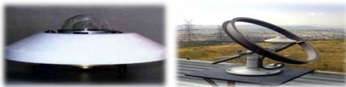
Εικόνα 1. Πυρανόμετρο μέτρησης της ολικής και της διάχυτης ακτινοβολίας [3] .
