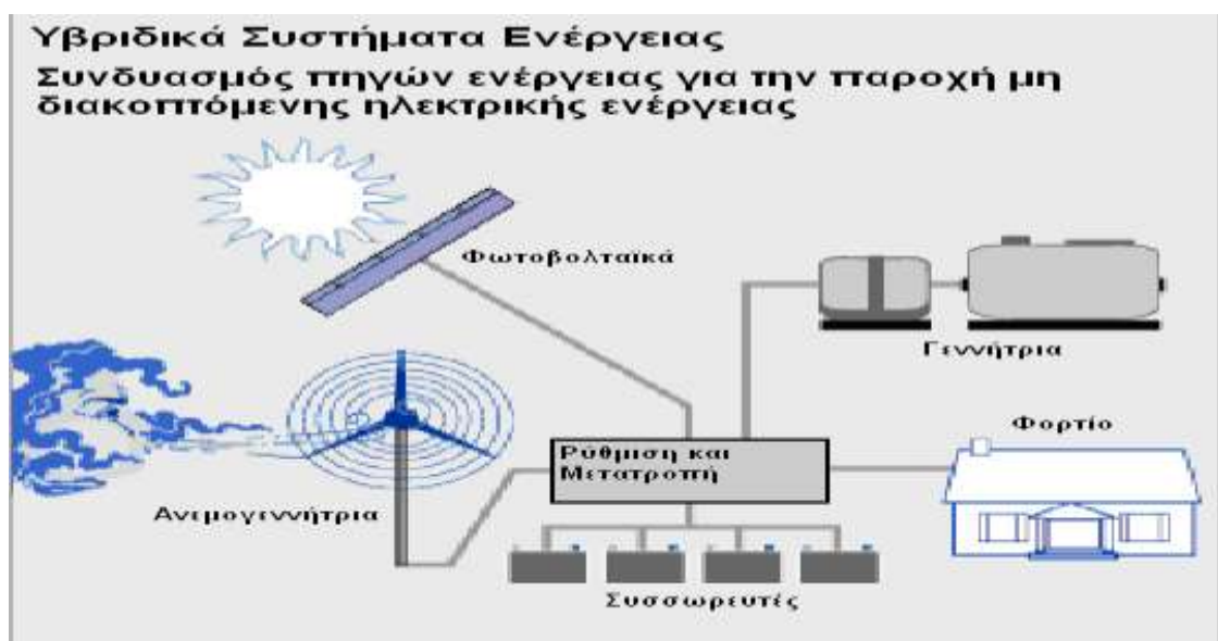
Σχήμα 17 Αναπαράσταση ενός τυπικού υβριδικού συστήματος [2].
