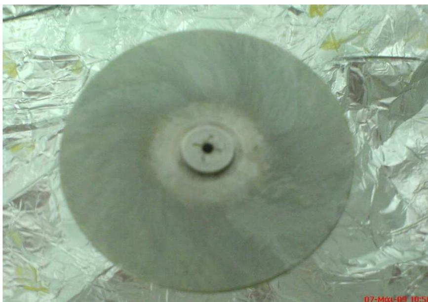
Εικόνα 5.Περιστρεφόμενη βάση τοποθέτησης δείγματος.
