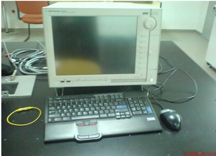
Εικόνα 10. Μηχάνημα μέτρησης I-V.
