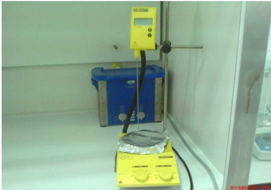
Εικόνα 2. Μαγνητικός θερμαινόμενος αναδευτήρας.
