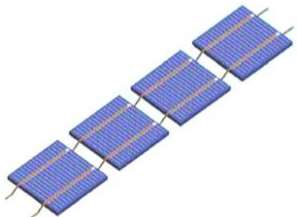
Σχήμα 2.5.24: Ηλεκτρική σύνδεση ηλιακών στοιχείων
