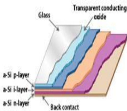
Σχήμα 2.5.31: Τομή άμορφου ΦΒ πλαισίου
