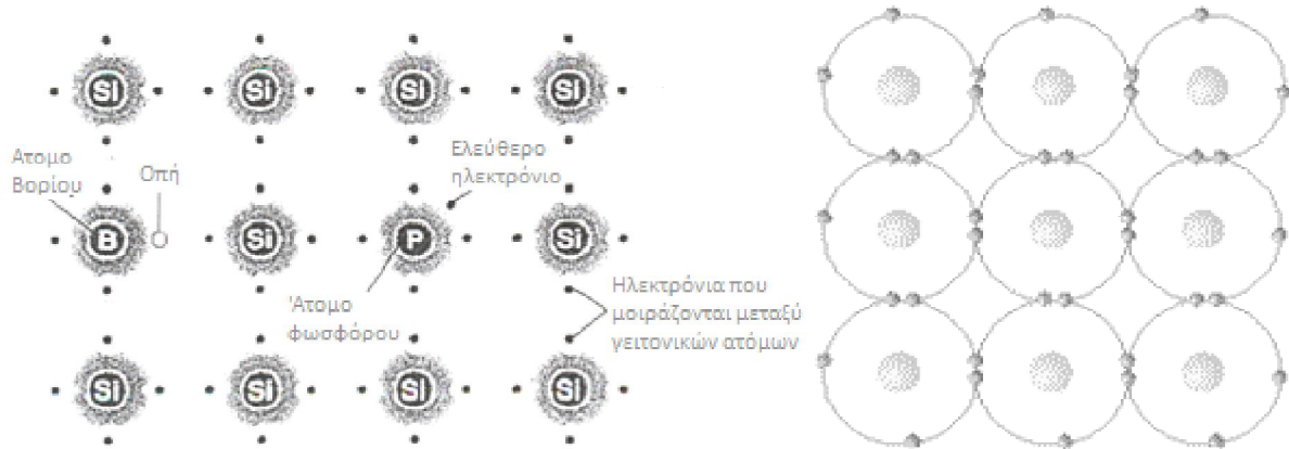
Σχήμα 2.1.3: Το κρυσταλλικό πλέγμα του πυριτίου Si
