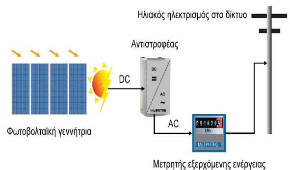
Σχήμα 7.9.6: Κύκλωμα με μετρητή για την ΔΕΗ
