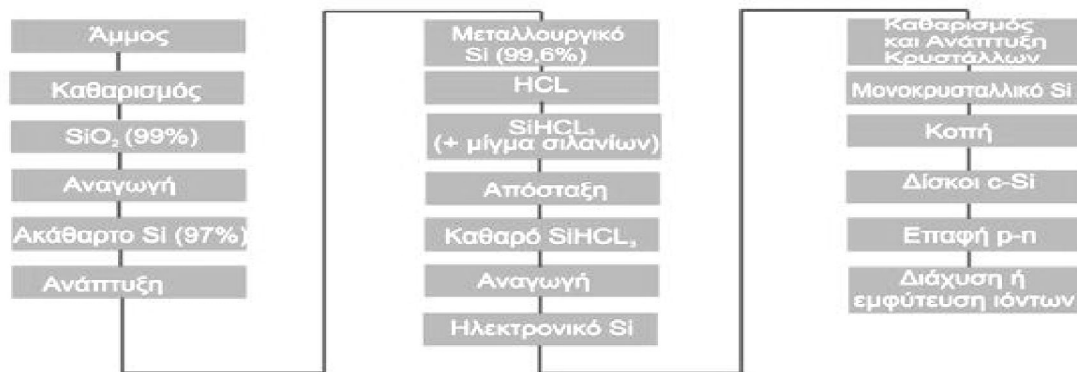
Εικόνα 2.1.1: Διάγραμμα ροής εργασιών παραγωγής ηλεκτρονικά καθαρού πυριτίου με την μορφή κυλίνδρου, με πρώτη ύλη από άμμο.
