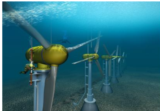
Σχήμα 1.3 : Σχηματική παράσταση υποθαλάσσιας ηλεκτρογεννήτριας.
