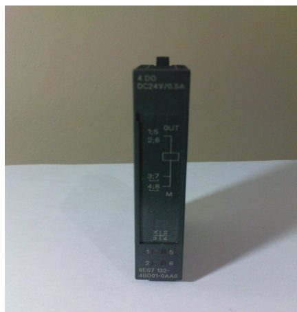
Εικόνα 1.1.2.7.3.2 : Μονάδα Ψηφιακής Εξόδου
