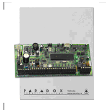
Εικόνα 1.2 Πλακέτα κεντρικού πίνακα
