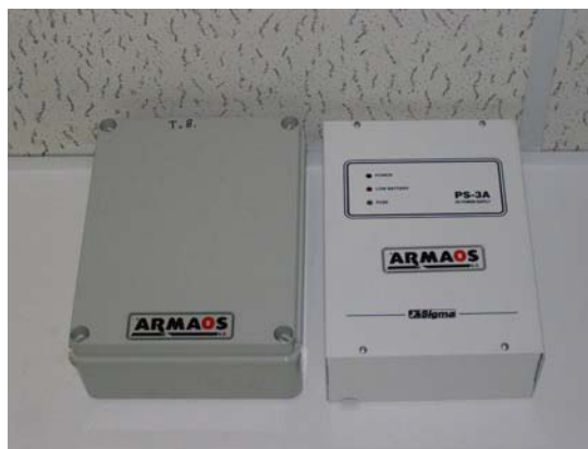
Εικόνα 5.4 Τροφοδοτικό sigma 12V και icon 100
