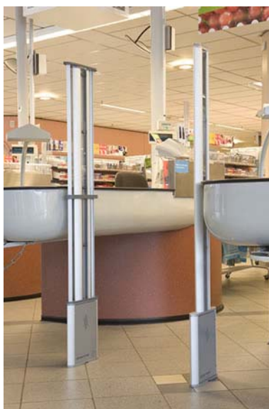
Εικόνα 3.1 Πυλώνες με ξεχωριστό πομπό και δέκτη
