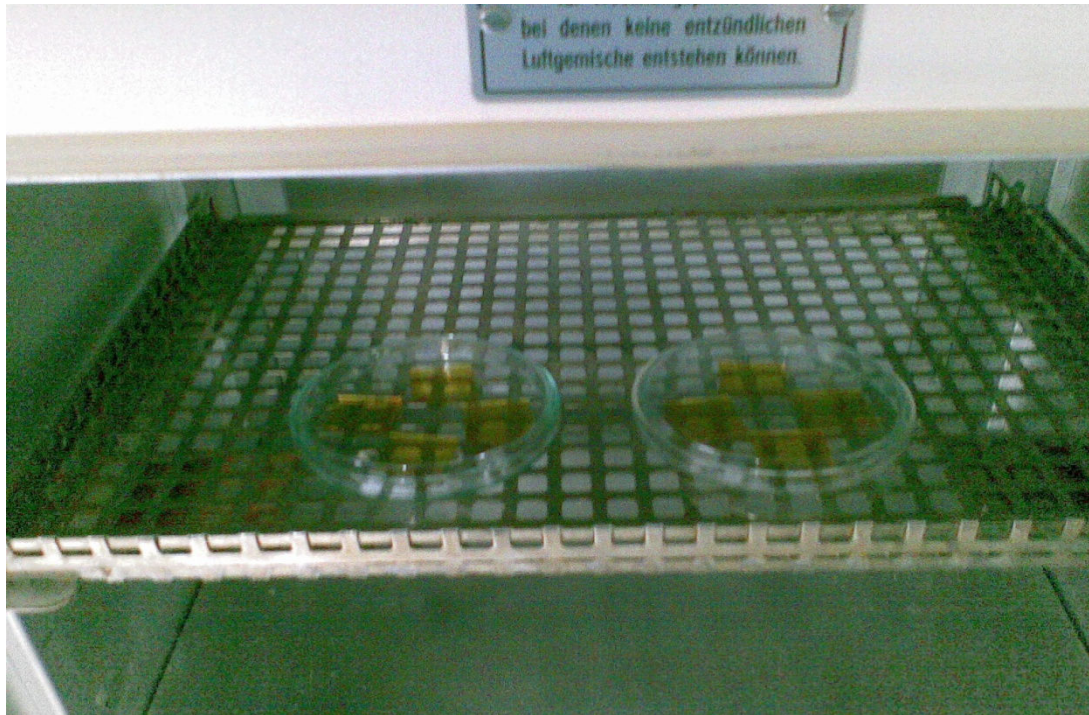
Εικόνα 4.5.8: Τοποθέτηση Δοκιμών με επίστρωση PEDOT:PSS σε ηλεκτρονικό φούρνο για στέγνωμα σε 110 °C. Για 60min.
