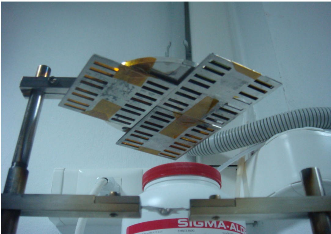
Εικόνα 4.7.4 : Βλέπουμε πως είναι από την κάτω όψη οι μάσκες όπου θα δεχθούν το αλουμίνιο.
