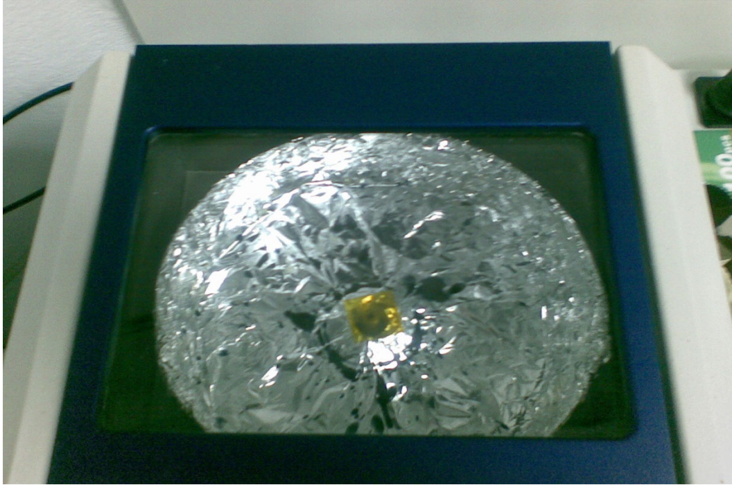
Εικόνα 4.5.6 : Τοποθέτηση Δοκιμίου για Διαδικασία Επίστρωσης εκ Περιστροφής.
