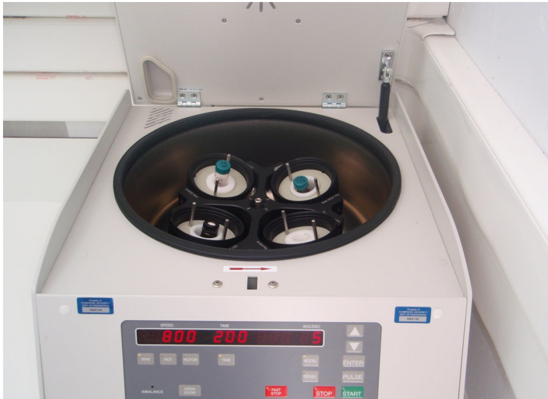
Εικόνα 4.4.6 : Ηλεκτρονική συσκευή περιστροφής διαλυμάτων για μέγιστη διαλυτότητα νανοδομών.
