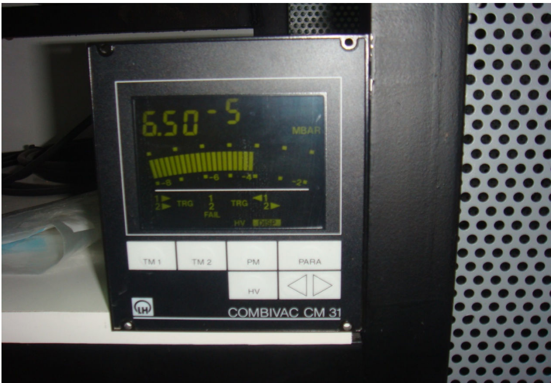
Εικόνα 4.7.6 : Επιθυμητή πίεση θαλάμου ώστε να δώσουμε ρεύμα και να γίνει η εξάχνωση.
