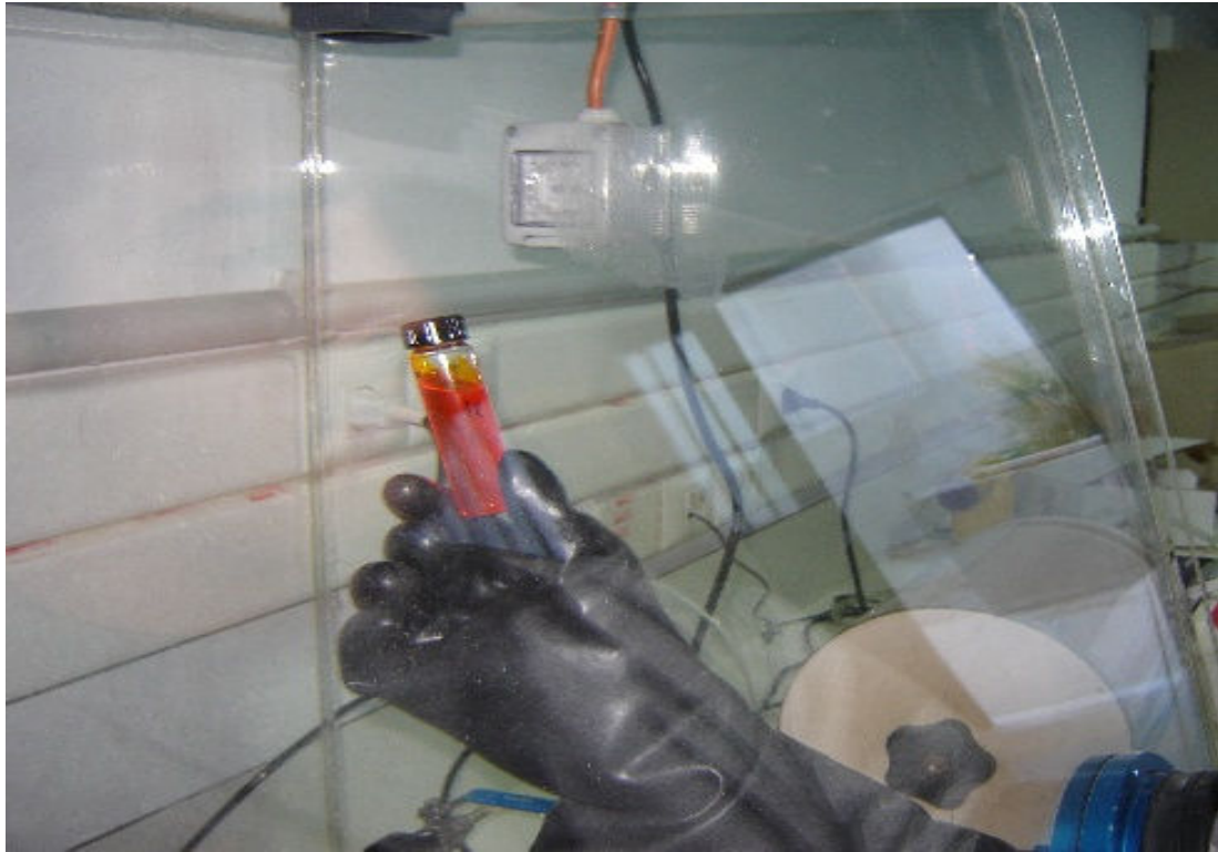
Εικόνα 4.4.4 : Δημιουργία Διαλύματος με προσθήκη Χλωροφορμίου σε Πολυμερές P3OT.
