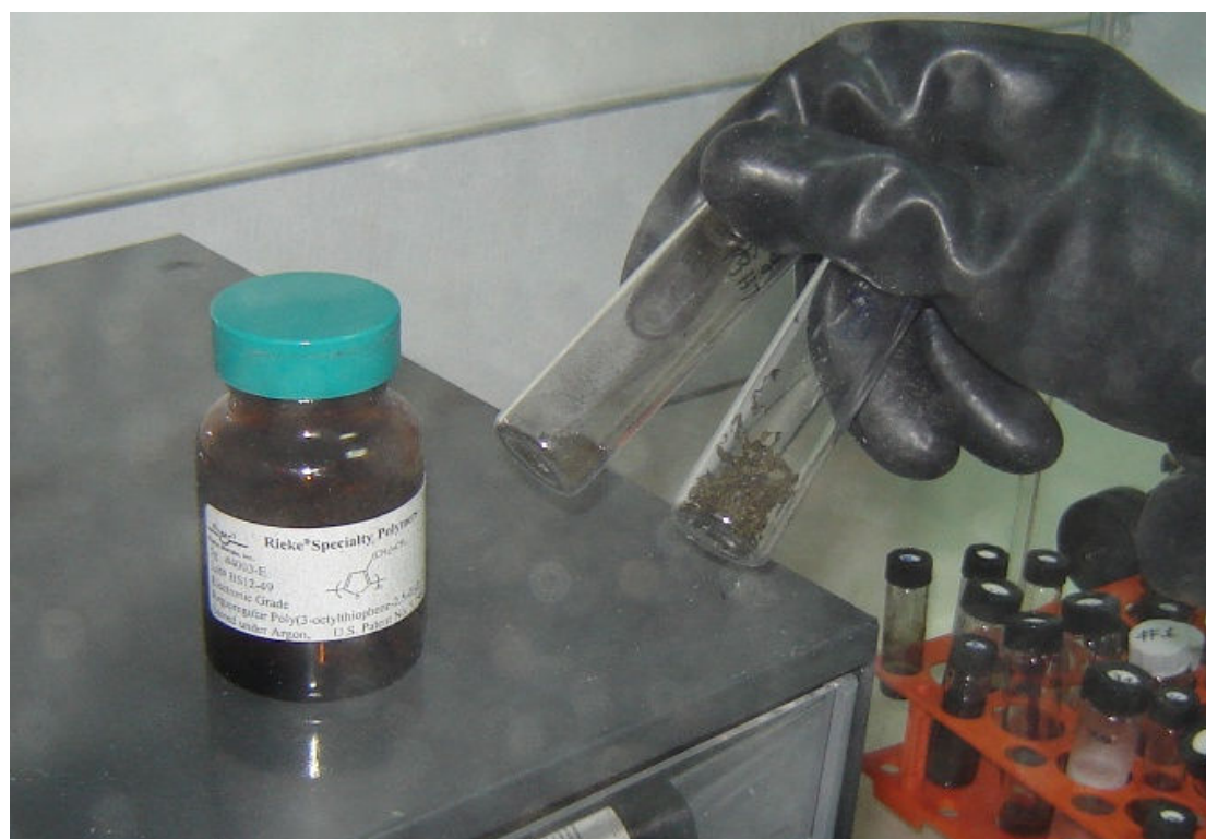
Εικόνα 4.4.3 : Διαλογή ποσοτήτων πολυμερούς (αριστερά 100mg P3HT, δεξιά 100mg P3OT) που θα χρησιμοποιηθούν σε πείραμα.
