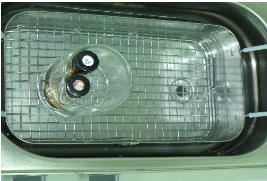
Εικόνα 4.4.5 : Αύξηση της Διαλυτότητας Νανοδομών στα Διαλύματά τους με χρήση Ultrasonic Bath.
