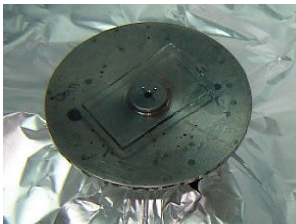
Εικόνα 4.5.5 : Τοποθέτηση δοκιμίου στη βάση της βαλβίδας της συσκευής.
