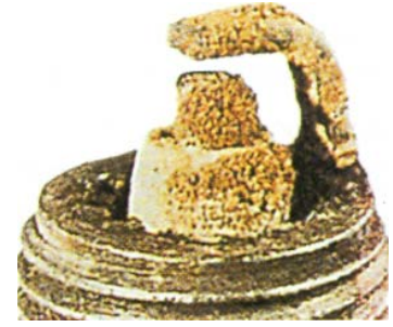
Λερωμένος αναφλεκτήρας από καύση λιπαντικού
