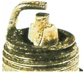
Κατεστραμμένη μόνωση κεντρικού ηλεκτροδίου
