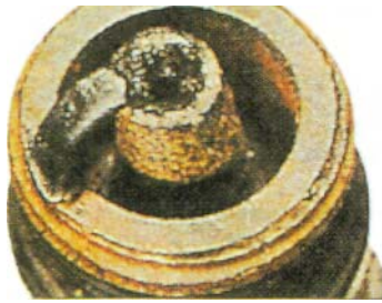
Κατεστραμμένο ηλεκτρόδιο γείωσης
