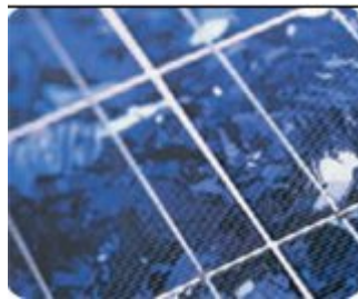
Σχ. 2.17 Φ/Β στοιχείο πολυκρυσταλλικού πυριτίου
