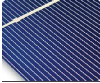
Σχ. 2.16 Φ/Β στοιχείο μονοκρυσταλλικού πυριτίου
