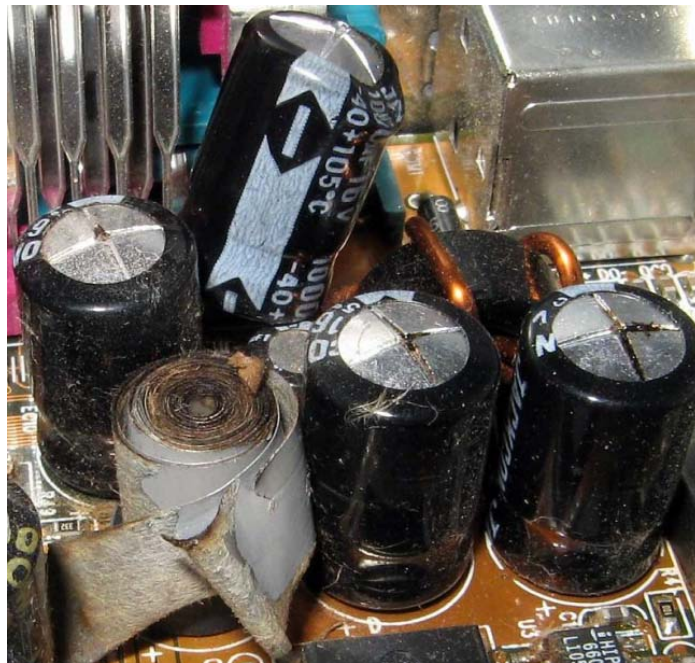
Εικόνα 14 Υπερθέρμανση σε πυκνωτές
