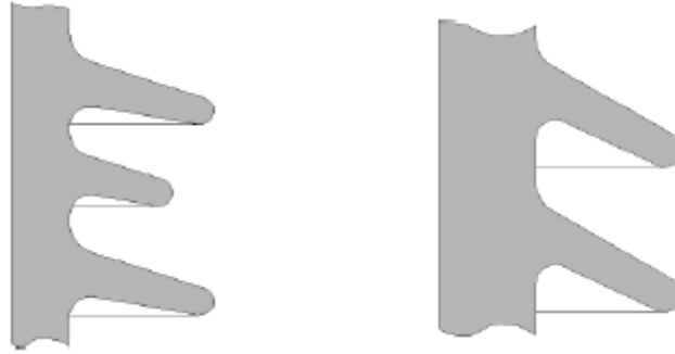
Εικ 10: Η εναλλαγή έριξε το σχεδιάγραμμα (αριστερά) και το κανονικό σχεδιάγραμμα υπόστεγων (δεξιά)
