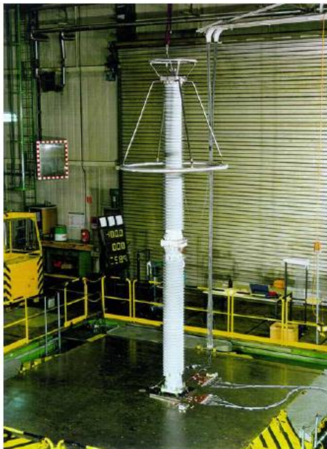
Εικ.. 21: Πολυμερών στεγάζεται σταματών για 550 -KV-συστήματος κατά τη διάρκεια σεισμικών δοκιμών σε σεισμικής τράπεζας.
