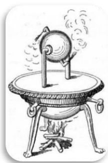
Εικόνα 1 Ατμοστρόβιλος του Ήρωνα
