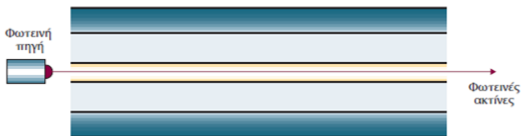
Εικόνα 20: Μονότροπη οπτική ίνα (single mode fiber optic)
