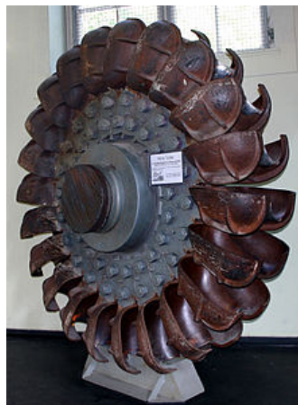
Εικ. 2.7. Δρομέας υδροστρόβιλος τύπου Pelton.
