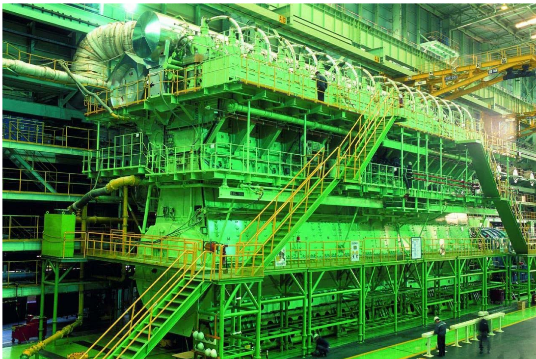
Εικ. 2.9. Ντιζελογεννήτρια WARTSILA 14 κυλίνδρων, RT-flex96C, 102 rpm, 80 MW.
