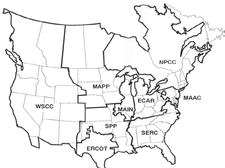
Εικ. 3.3. Χάρτης Βορείου Αμερικής με τα διακριτά τοπικά ηλεκτρικά συστήματα. Το διασυνδεδεμένο αυτό ΣΗΕ διαχειρίζεται από το συμβούλιο ηλεκτρικής αξιοπιστίας Βορείου Αμερικής (North America Electric Reliability Council, NERC).
