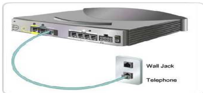
Εικόνα 41: Σύνδεση Router σε τηλεφωνική πρίζα (DSL σύνδεση)
