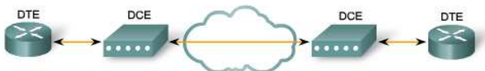
Εικόνα 42: WAN σύνδεση μέσω DCE και DTE συσκευών
