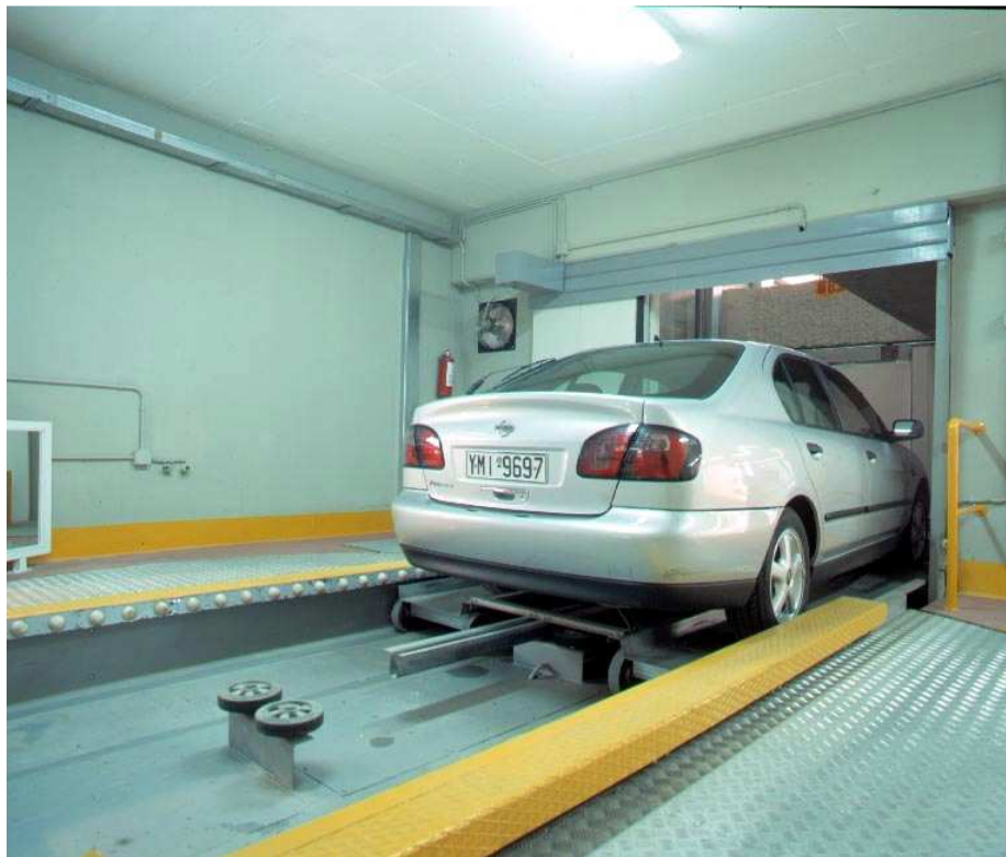
Εικόνα 8: Τρόπος παραλαβής του οχήματος από την κινούμενη πλατφόρμα
