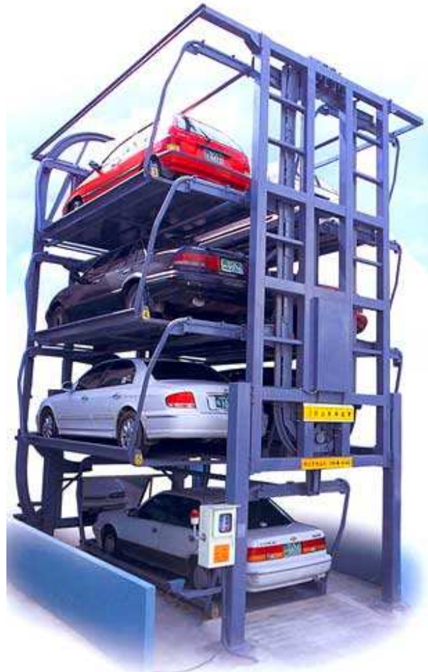
Εικόνα 1: Στάθμευση αυτοκινήτων με αυτόματο σύστημα στάθμευσης
