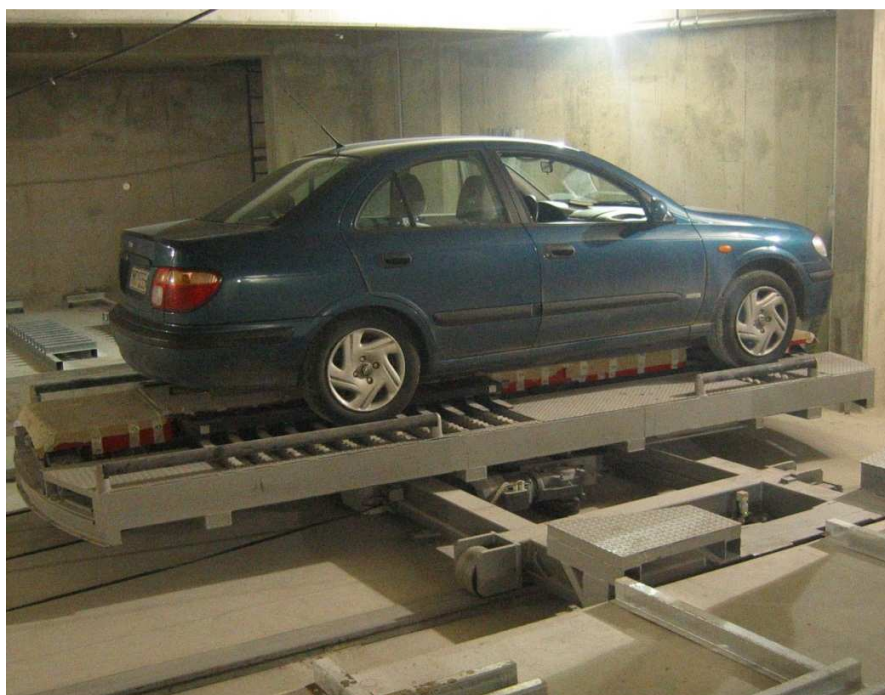
Εικόνα 14: Τρόπος τοποθέτησης του αυτοκινήτου στο χώρο στάθμευσης
