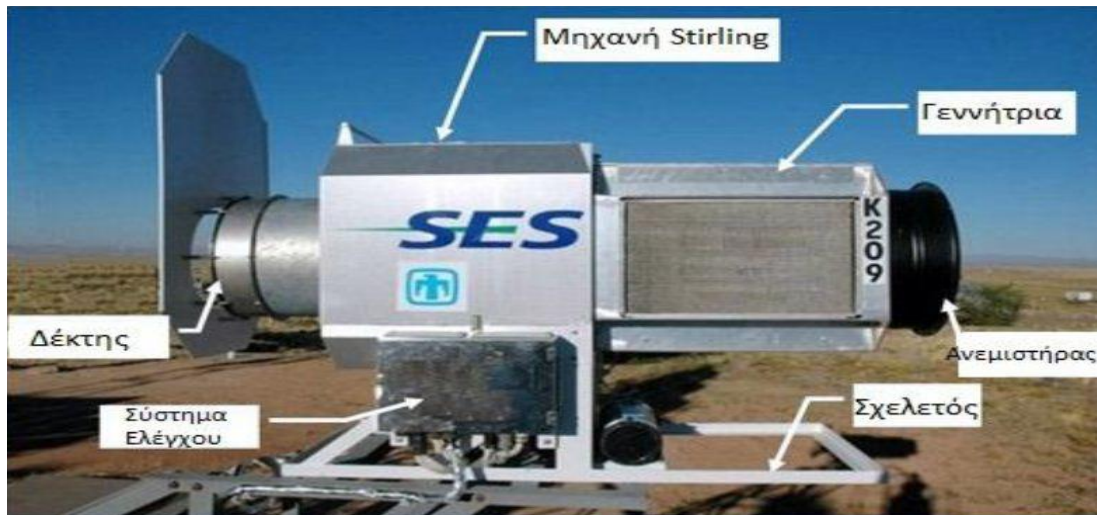
Εικ. 4.4 Σύστημα μετατροπής ενέργειας του συστήματος "Suncatcher".
