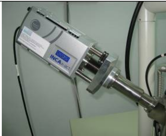
Το σύστημα EDX που σχετίζεται με το SEM.
