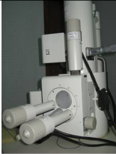
Η θύρα φόρτωσης, και χειριστήρια ελέγχου του SEM.
