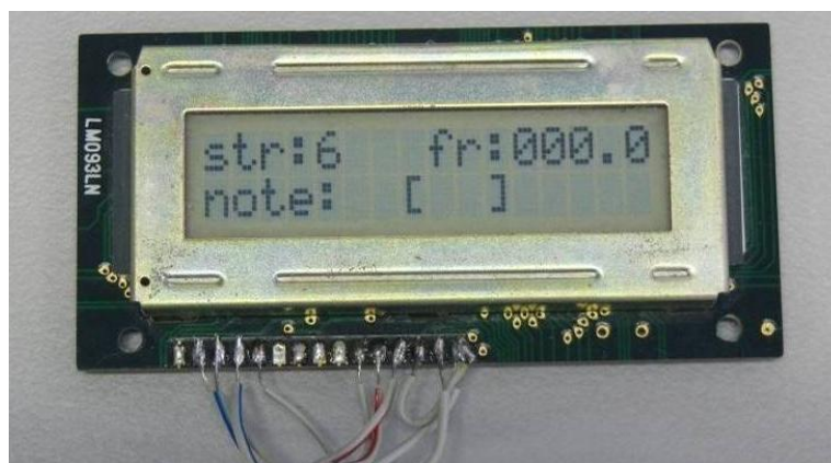
Σχήμα 24. Η μονάδα της LCD οθόνης “PowerTip 1602F-B”.
