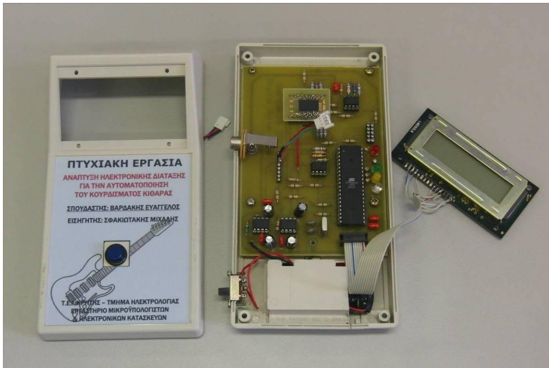
Σχήμα 27. Η πλακέτα τοποθετημένη στο κουτί, με την οθόνη και την πρόσφυση δίπλα.
