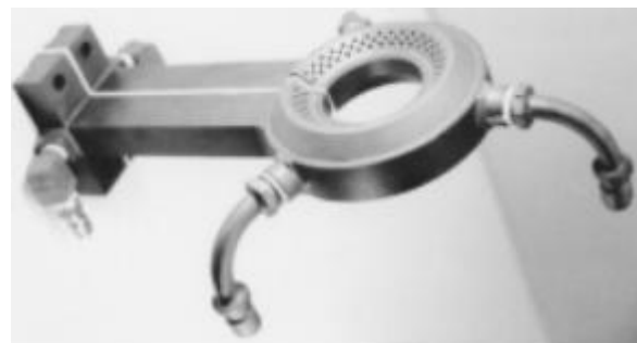
Εικόνα 3.19: Μιας σπείρας πηνίο- Στιγμαία Θέρμανση
