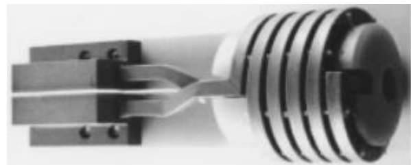
Εικόνα 3.27: Πολλών τετραγωνικών σπειρών εσωτερικό πηνίο
