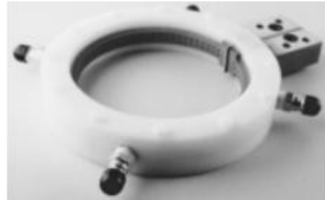
Εικόνα 3.19: Μιας σπείρας πηνίο- Στιγμαία Θέρμανση
