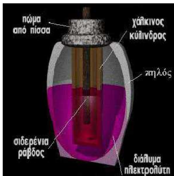
Σχήμα 2.2: Η μπαταρία της Βαγδάτης. Μια πρωτόγονη μπαταρία περίπου του 200 πΧ.
