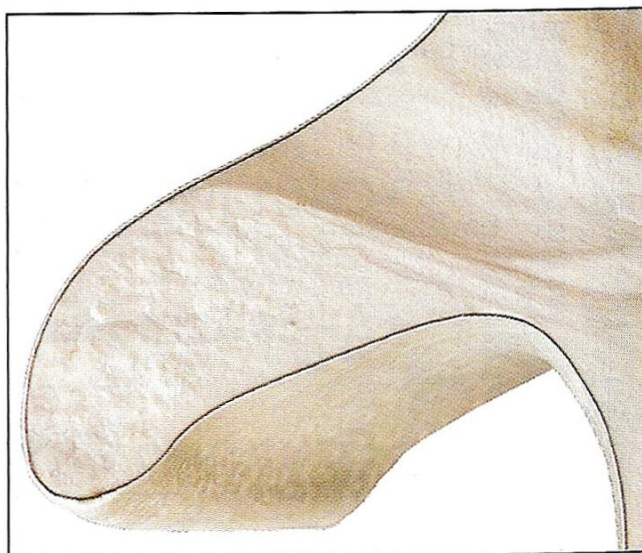
Εικόνα 2.4.1 : τομή τμήματος μονωτήρα στηρίξεως πορσελάνης 150KV, όπου διακρίνεται η επικάλυψη από RTV SIR
