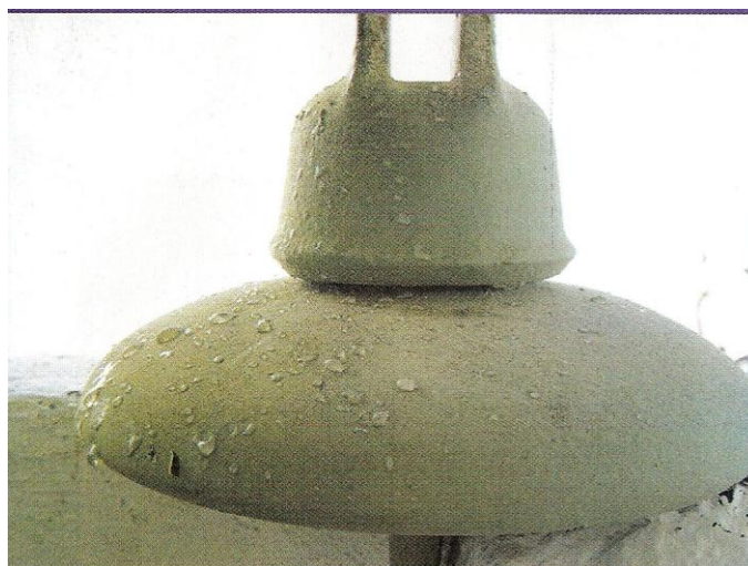
Εικόνα 2.4.2 : Υδρόφοβη συμπεριφορά, παρά την παρουσία ρύπων, στην επιφάνεια ενός μονωτήρα πορσελάνης τύπου Cap and Pin με επικάλυψη από RTV SIR
