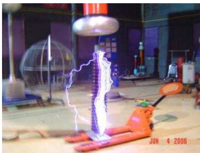
Κεραμικός μονωτήρας σε δοκιμή υψηλής τάσης με πηνίο Tesla
