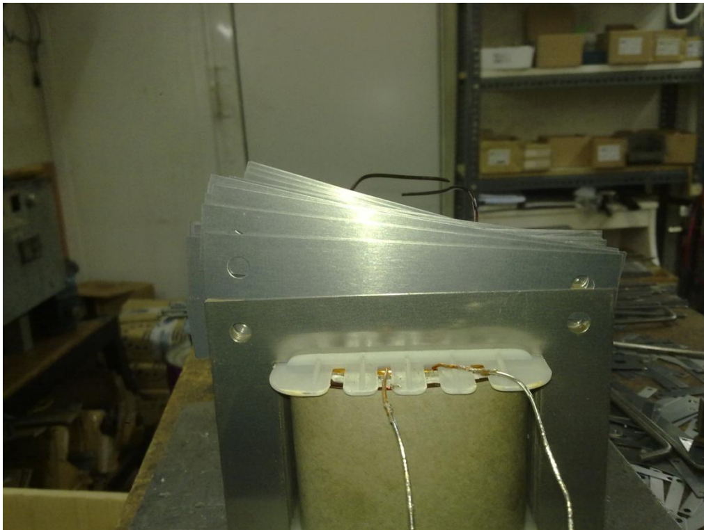
[Φωτογραφία 9] Τοποθέτηση ελασμάτων I 150
