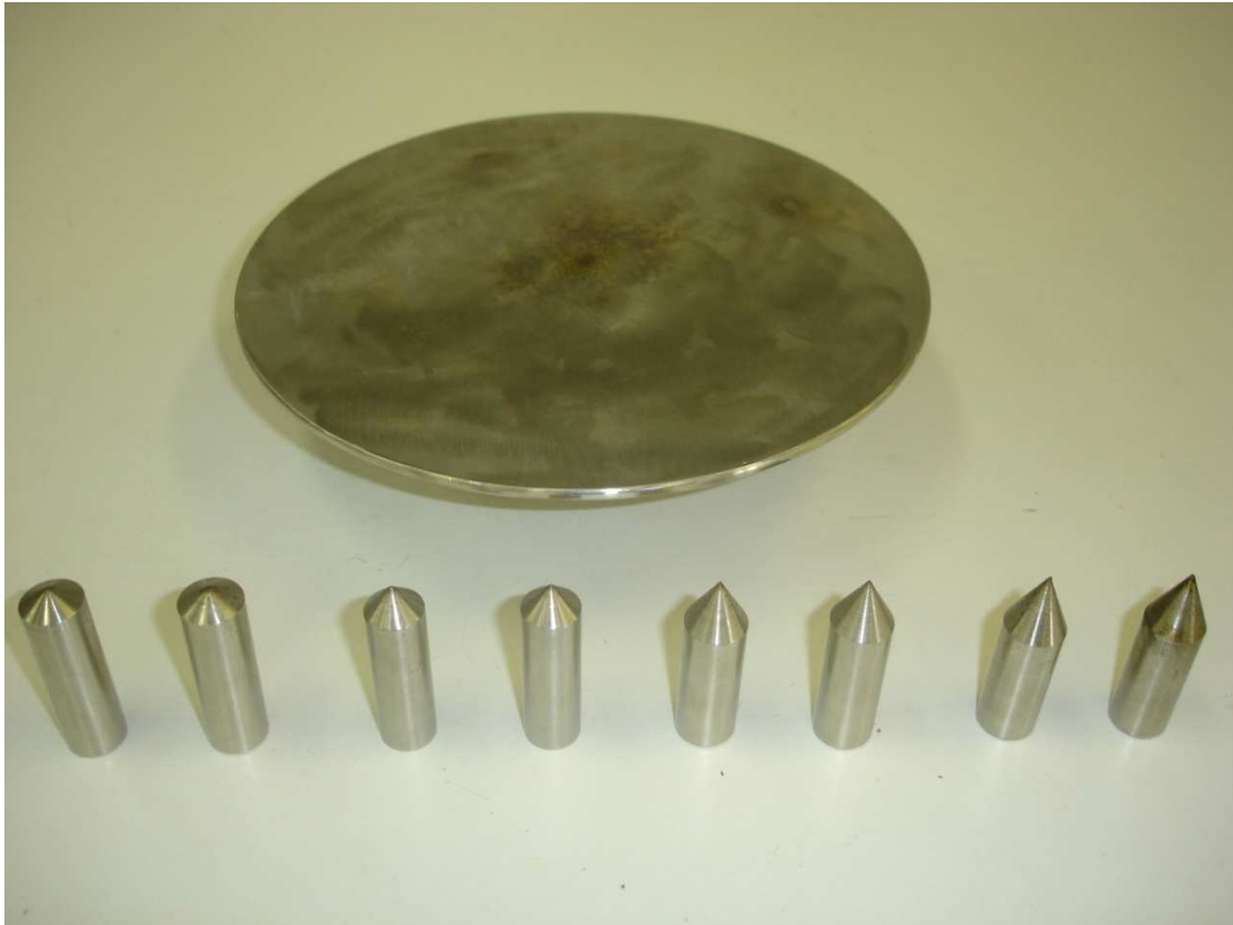
Σχήμα 3.3 Διάκενα αέρος, πλάκα και ακίδες 30^\circ , 60^\circ , 90^\circ και 120^\circ
