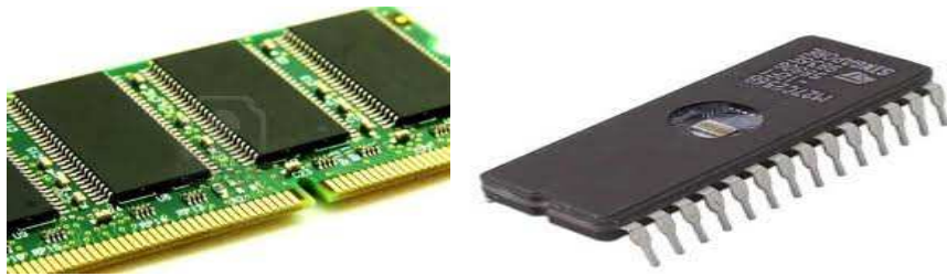
β4: εικονίζεται η μνήμη RAM και EPROM του PLC.
