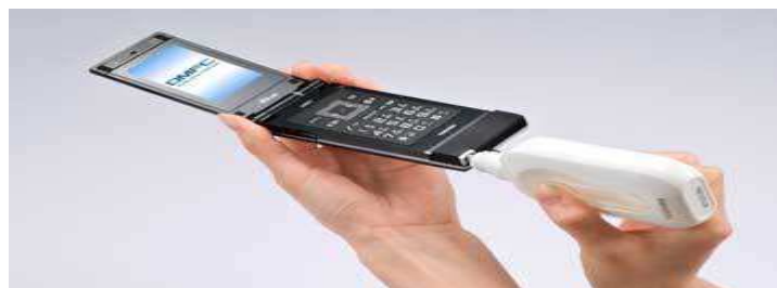
Σχήμα 1.13: Κινητό τηλέφωνο με μπαταρία κυψέλης καυσίμου τροφοδοσίας μεθανόλης
