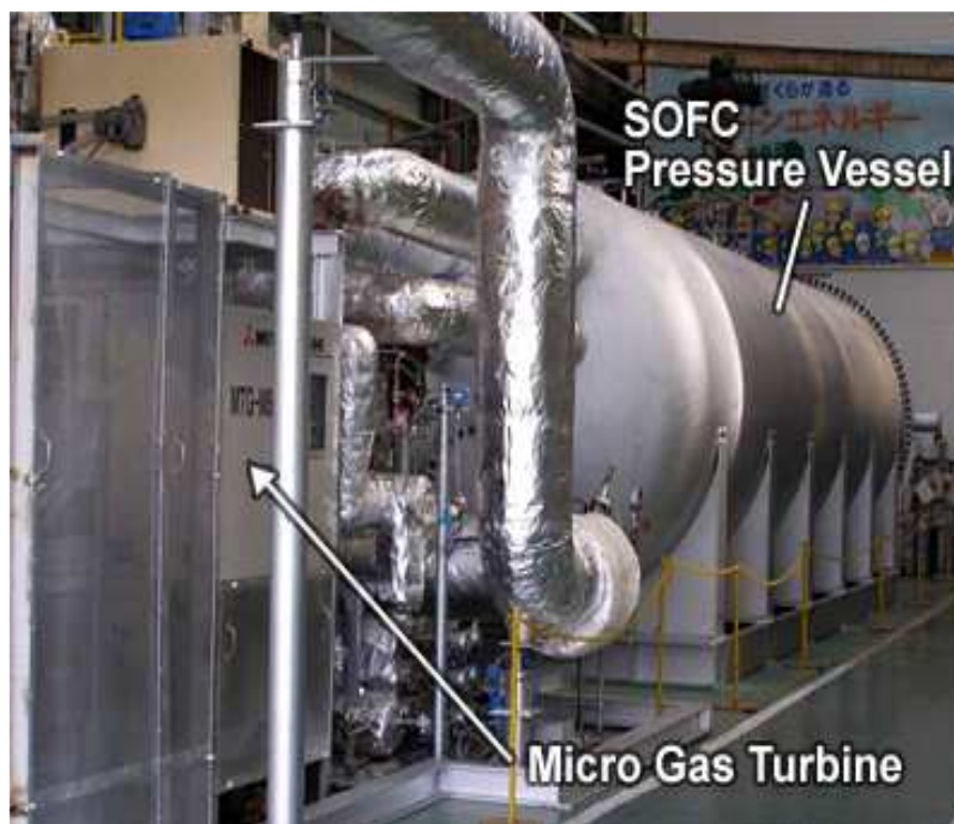
Σχήμα 4.16: 200 kw sofc σύστημα συμπαραγωγής ηλεκτρικής ενέργειας.[78]
