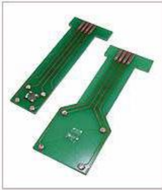
Εικ.19 PCB για συγκράτηση δείγματος (6mm x 6mm, 20mm x 20mm)
