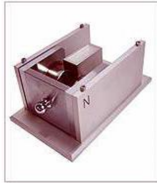
Εικ.20 Πυκνότητα μαγνητικής ροής στο σύστημα εισόδου 0.55T ή 1.0T
