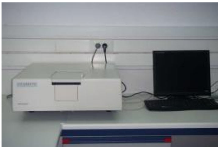
Εικ.33: Φασματοφωτόμετρο υπεριώδους-ορατού Shimadzu 2401-PC
