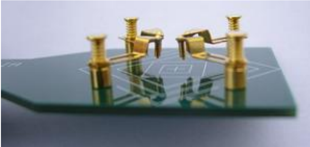
Εικ.23: Το Spring Clip είναι για την τοποθέτηση δειγμάτων πάχους 2mm έως και 4,5 mm
