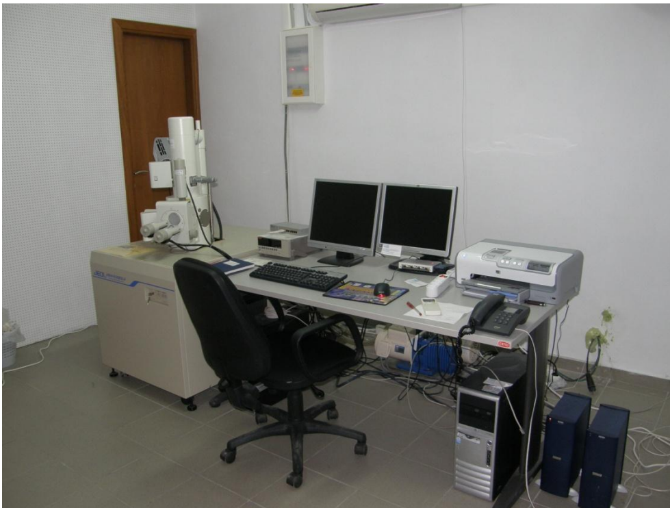
Εικ.12: Ηλεκτρονικό μικροσκόπιο σάρωσης (Scanning Electron Microscopy, S.E.M) Κέντρο Έρευνας Τεχνολογίας Υλικών και Φωτονικής, Κ.Ε.Τ.Υ.Φ. - Τ.Ε.Ι. Ηρακλείου
