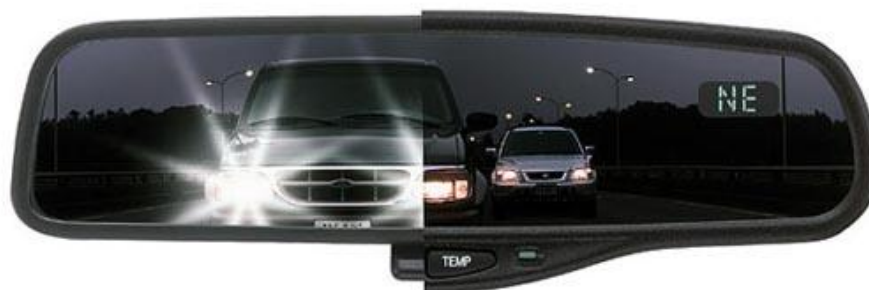
Εικόνα 1.4: Ηλεκτροχρωμικός καθρέπτης αυτοκινήτου της εταιρίας Gentex.
