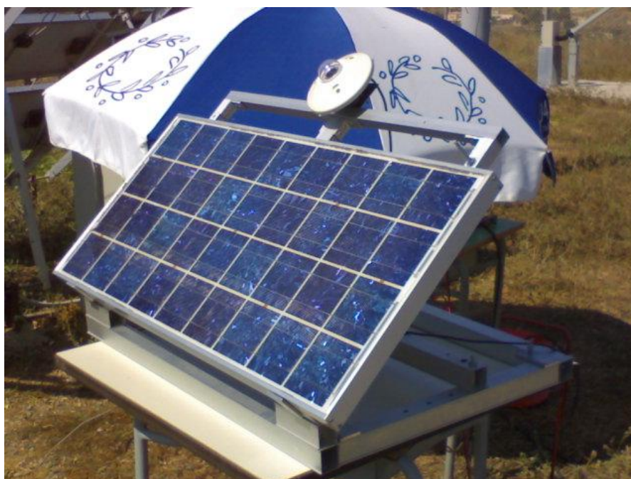
Εικόνα 2.7.5.1 Η βάση με το πυρανόμετρο και ένα ΦΒ πλαίσιο πάνω της
