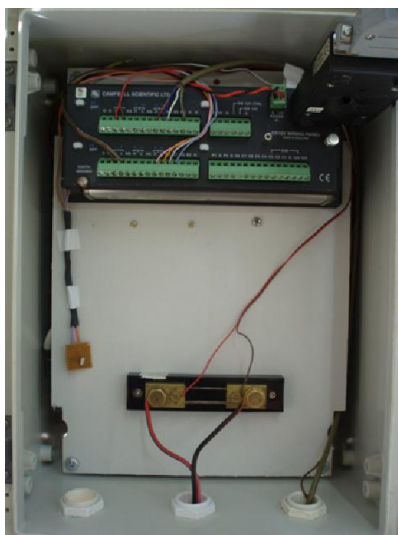
Εικόνα 3.1.2 Ο datalogger συνδεδεμένος με τη shunt
