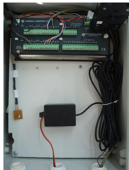
Εικόνα 3.1.3 Ο datalogger συνδεδεμένος με διαιρέτη
