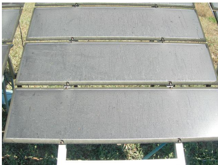
Εικόνα 3.1.1 Επικάθιση σκόνης (2 μηνών) και άλλων σωματιδίων πάνω σε ΦΒ πλαίσια
