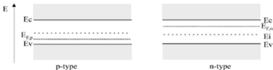
Σχήμα 4.2 Σχηματική αναπαράσταση Ενεργειακών Επιπέδων Επαφής p-n.
