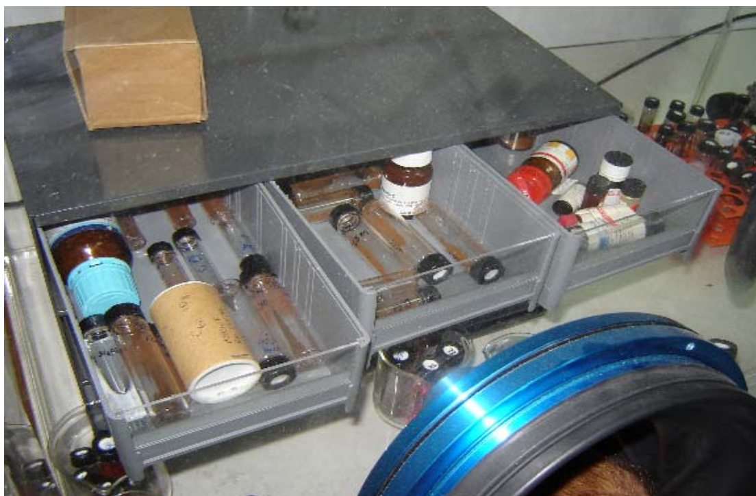
Εικόνα 5.1: Αποθηκευτικός χώρος ζυγισμένων ποσοτήτων Πολυμερών-Νανοδομών εντός του Glove-Box.
