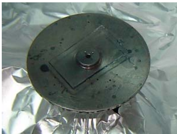
Εικόνα 5.7: Τοποθέτηση Δοκιμίου για Διαδικασία Επίστρωσης εκ Περιστροφής.
