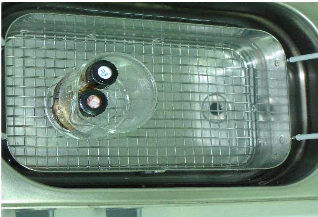
Εικόνα 5.4 : Αύξηση της Διαλυτότητας Νανοδομών στα Διαλύματα τους με χρήση Ultrasonic Bath.
