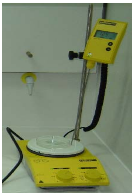
Εικόνα 5.8 : Τοποθέτηση Δοκιμίων με επίστρωση PEDOT:PSS σε Θερμαινόμενη Εστία για στέγνωμα σε 120 °C.
