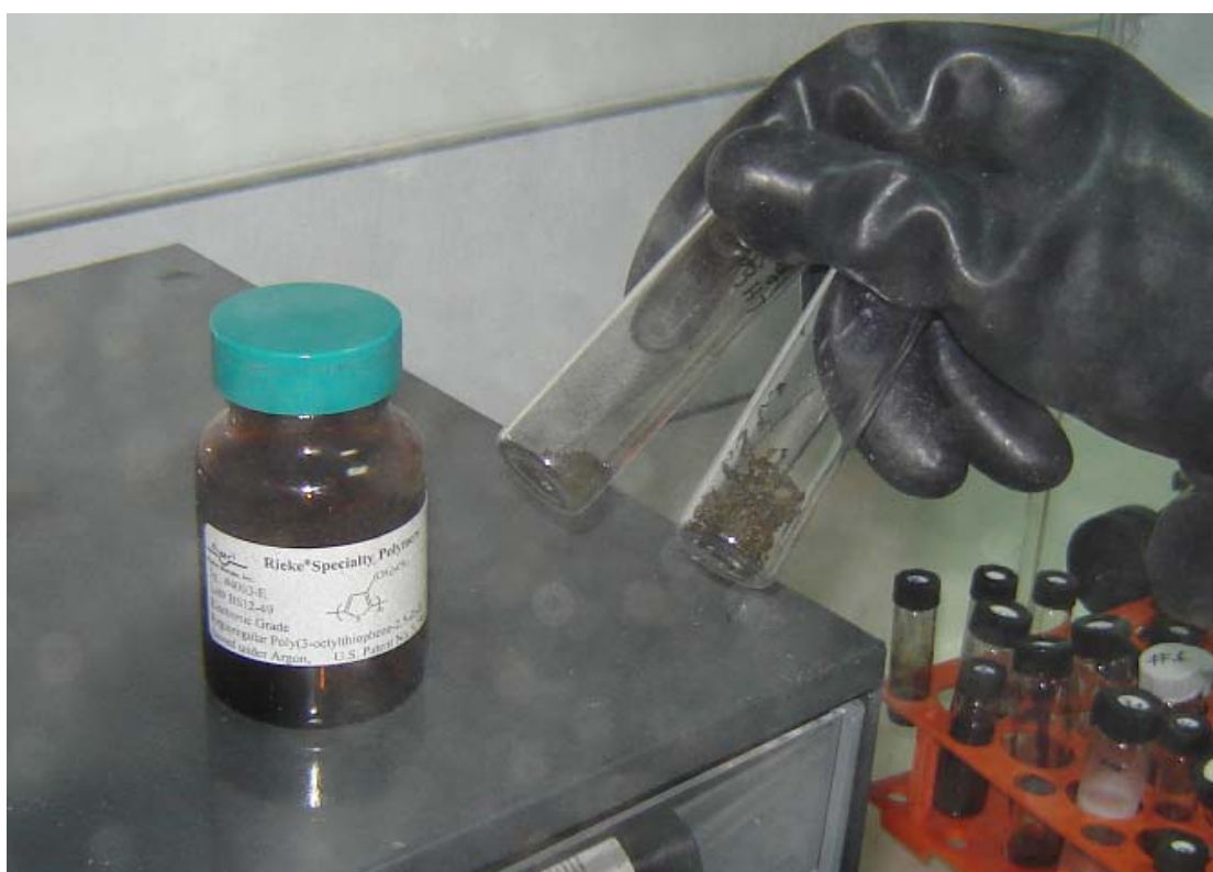
Εικόνα 5.2 : Διαλογή ποσοτήτων πολυμερούς (αριστερά 100mg P3HT, δεξιά 100mg P3OT) που θα χρησιμοποιηθούν σε πείραμα.
