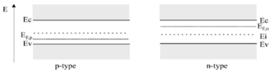
Σχήμα 4.2 Σχηματική αναπαράσταση Ενεργειακών Επιπέδων Επαφής p-n.
