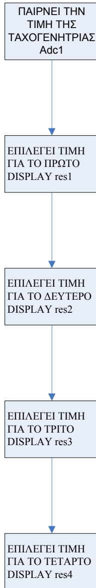
Σχήμα (Α.2) Λογικό διάγραμμα υπορουτίνας display.
