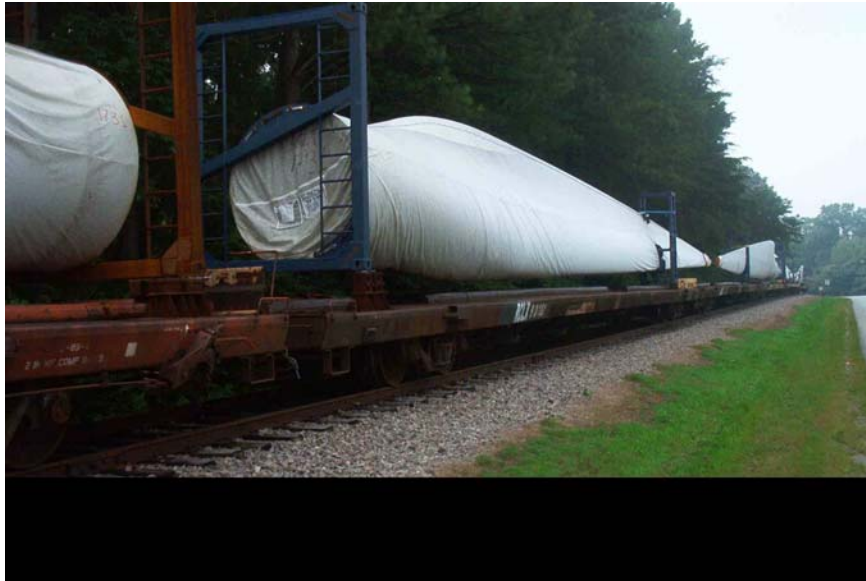
Εικ.1.1 Μεταφορά φτερού E-40. (www.enercon.com).
