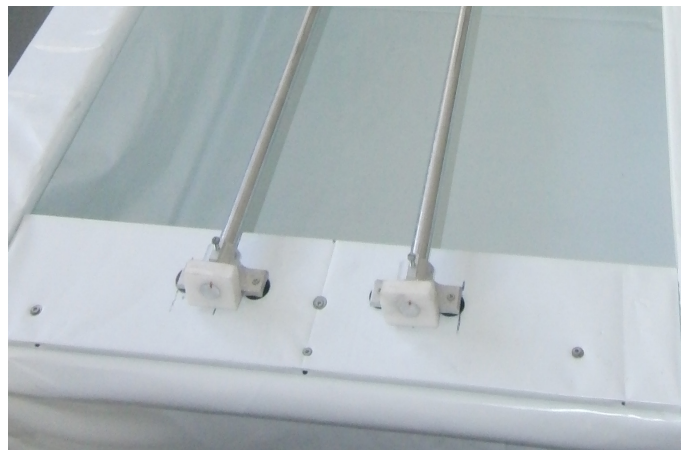
Σχήμα 22. (α) Όψη από την κάτω πλευρά του φορείου με το μηχανισμό του πτερυγίου. (β) Η προσαρμογή των οδηγών κίνησης στη δεξαμενή.
