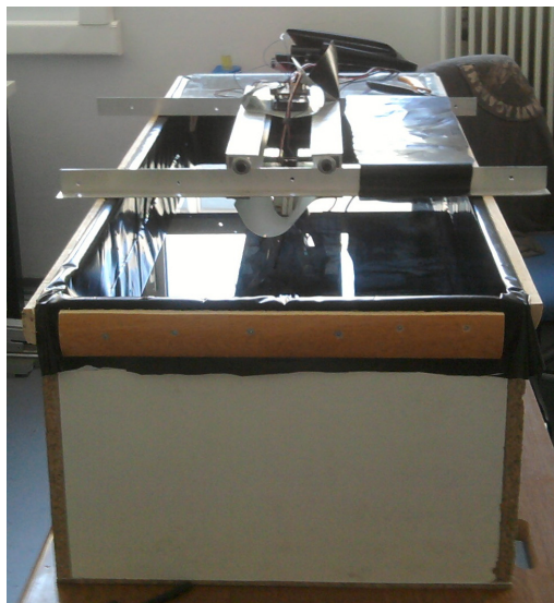
Σχήμα 24. Η μικρή δεξαμενή δοκιμών με εσωτερική επένδυση από φύλλο πολυαιθυλενίου και με προσαρτημένο το πρώιμο πτερόγιο
