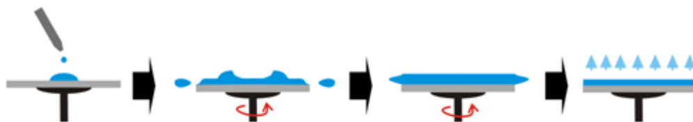
Σχήμα(13) Σχηματική αναπαράσταση της μεθόδου spin coating
