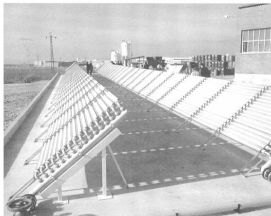
Σχήμα(8) Φωτογραφία ενός πρωτότυπου παραβολικού συλλέκτη (CPCs) (100m 2 ) για φωτοκατάλυση στη βιομηχανία Hidrocen (Arganda del Ray, Madrid, Spain) [50]
