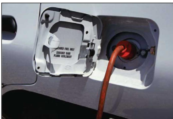
Σχήμα 5.1 Η πρίζα με την οποία ένα PHEV συνδέεται με εξωτερική πηγή ηλεκτρικού ρεύματος
