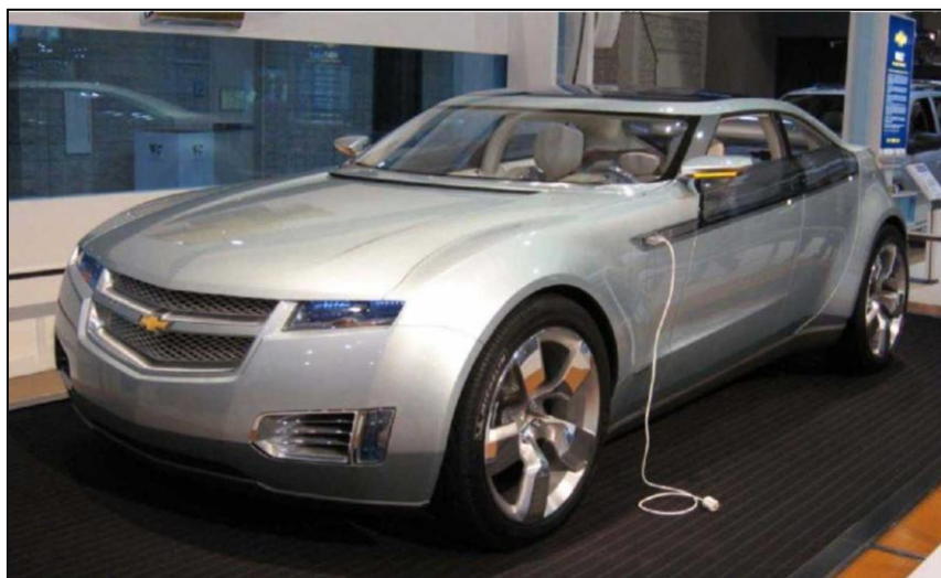
Σχήμα 5.22 Το σειριακό plug-in υβριδικό, Chevrolet Volt, της GM
