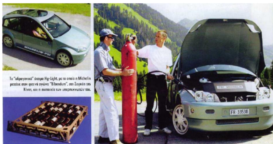
Σχήμα 5.13 Το υδρογονικό όχημα Hy-Light και η συστοιχία των υπερπυκνωτών του.
