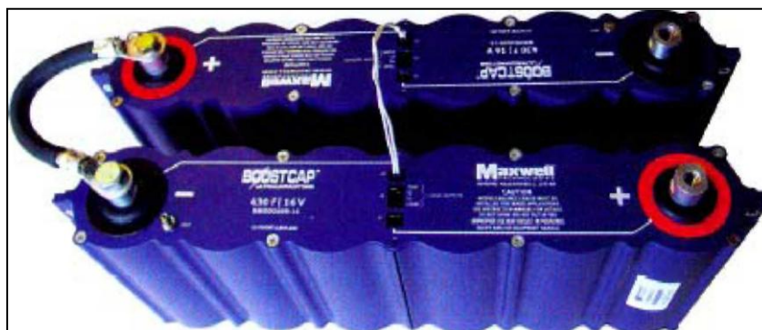
Σχήμα 5.9 Ο MC2600 της Maxwell: 2600 F στα 2,7 V που θα χρησιμοποιηθεί στις συστοιχίες BMOD2600-48 των 35 υβριδικών, πειραματικών λεωφορείων της ISE Research.
