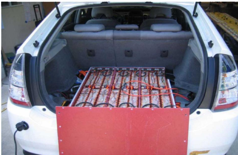
Σχήμα 5.4 Συστοιχία μπαταριών Lithium-ion, με ανοιχτό το κάλυμμα, στο "PRIUS+" που αποτελεί plug-in μετατροπή του υβριδικού Toyota Prius
