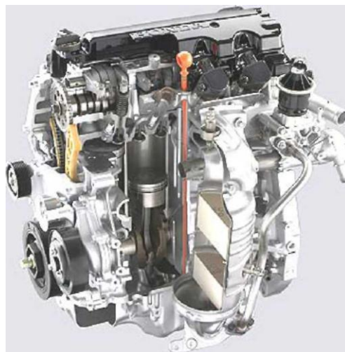
Σχήμα 7.23 Ο κινητήρας του Honda Civic Hybrid
