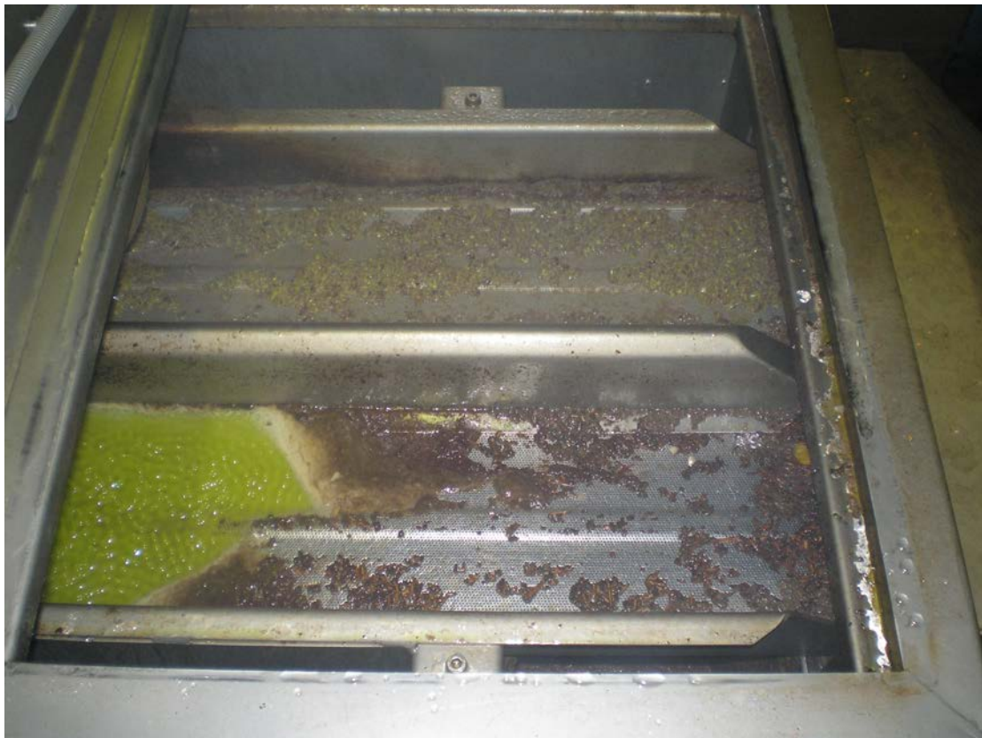
Εικόνα 28 decanter δεξιά το λάδι και από αριστερά τα απόβλητα
