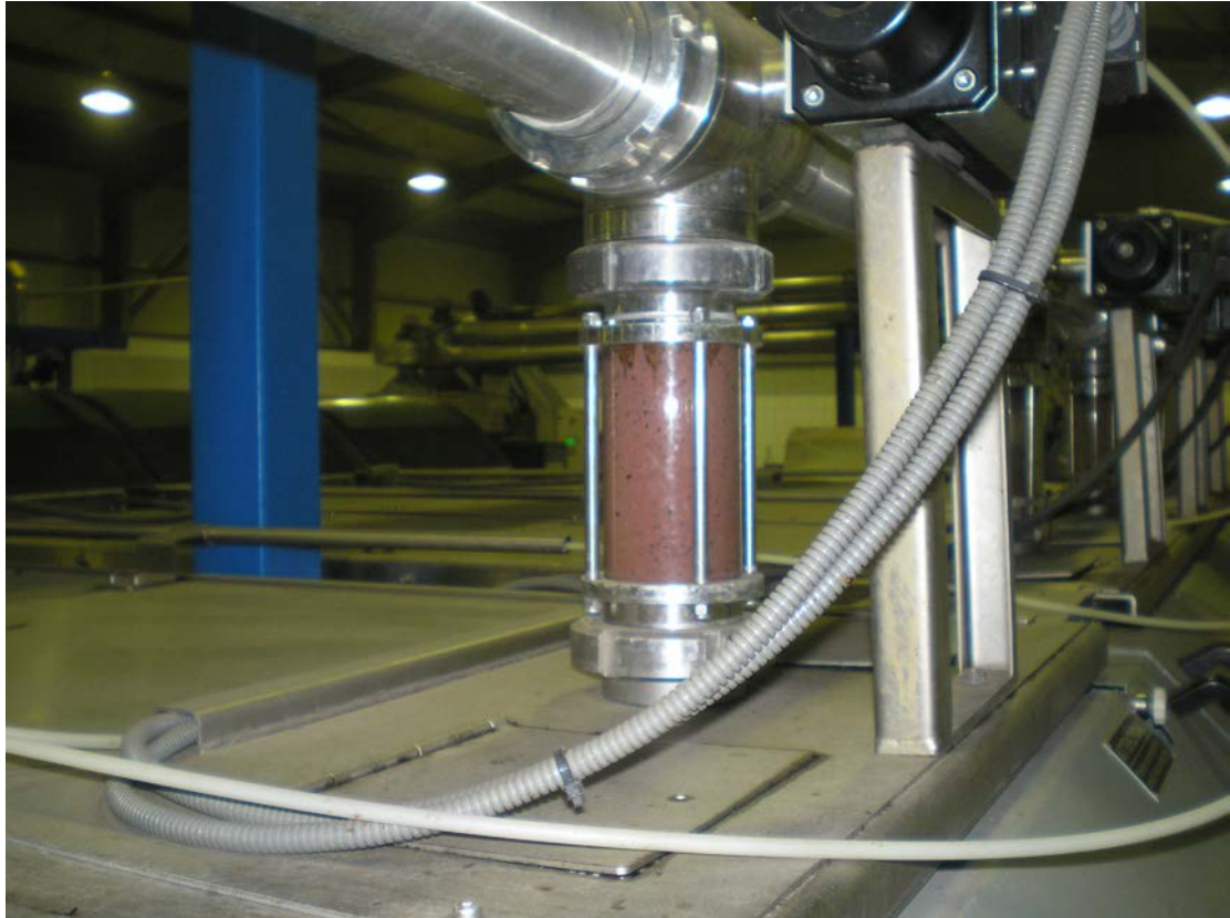
Εικόνα 26 η ηλεκτροβάννα που κανονίζει σε ποια σκάφη θα πέσει η ζύμη
