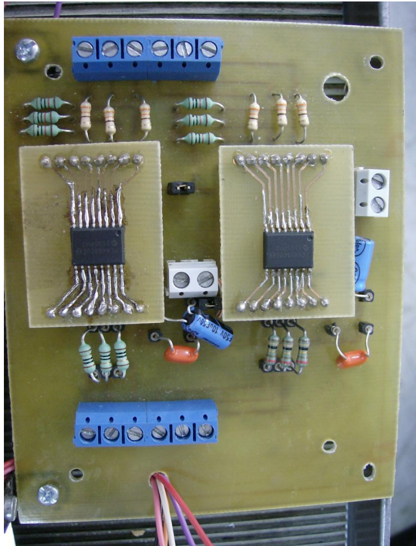
Εικ. Δ.8. Ολοκληρωμένη άποψη του κυκλώματος οδήγησης των διακοπτικών στοιχείων (MOSFET) που κατασκευάσαμε.
