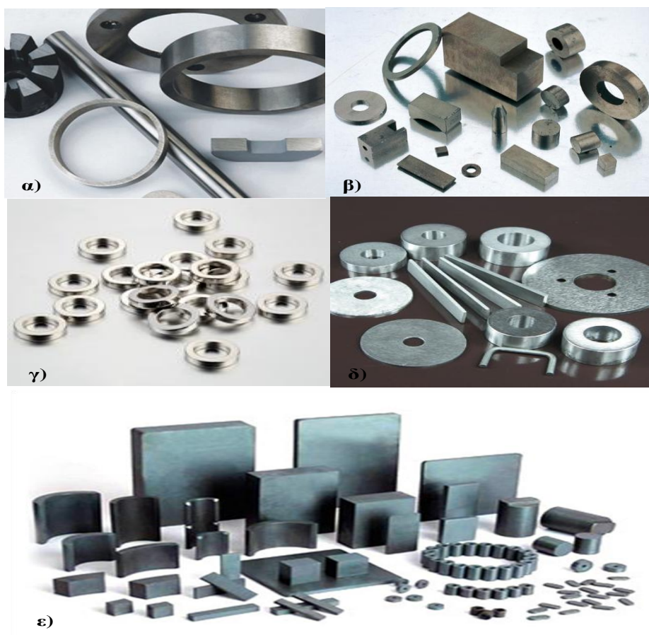
Εικ. 1.1 Είδη μόνιμων μαγνητών α) Alnico , β) SmCo, γ) NdFeB, δ) FeCrCo και ε) φερρίτες
