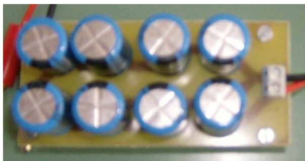
Εικ. Δ.11 Ολοκληρωμένη άποψη του κυκλώματος πυκνωτή (φίλτρο εισόδου αντιστροφέα) που κατασκευάσαμε
