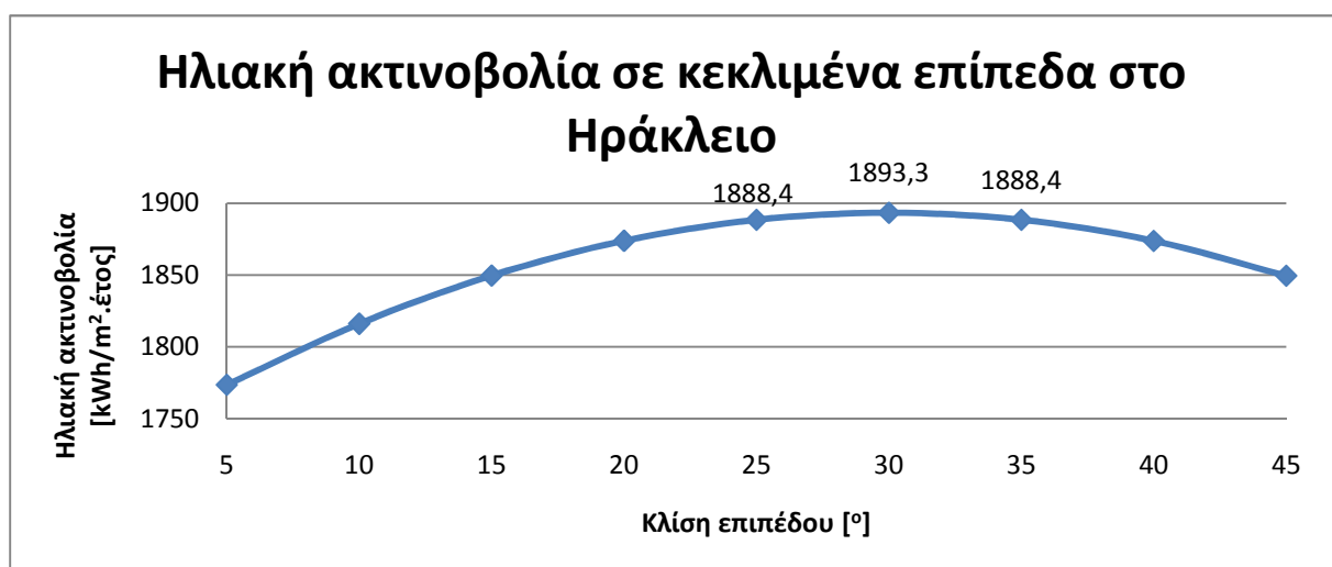
Σχήμα 3.1: Υπολογισμός ηλιακής ακτινοβολίας σε κεκλιμένα επίπεδα στο Ηράκλειο της Κρήτης
