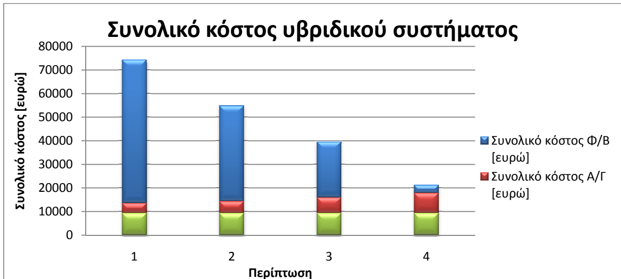
Σχήμα 3.4: Διάγραμμα συνολικού κόστους με βάση τις περιπτώσεις κατανομής ποσοστού ηλεκτροπαραγωγής από φωτοβολταϊκό σύστημα, σύστημα ανεμογεννητριών και ηλεκτροπαραγωγό ζεύγος
