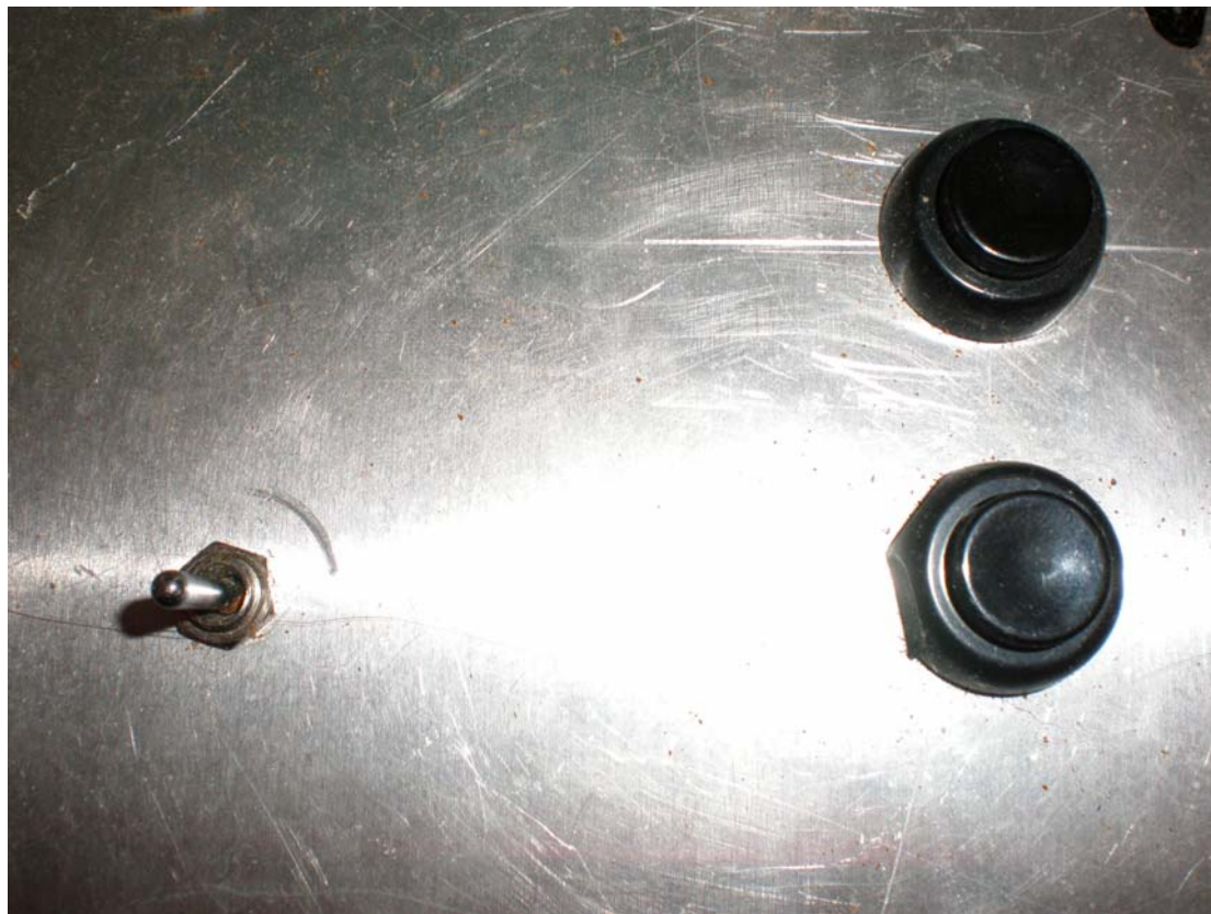
Εικ.17 Διακόπτης λειτουργίας του μοτέρ2 και μπουτόν μοτέρ1
