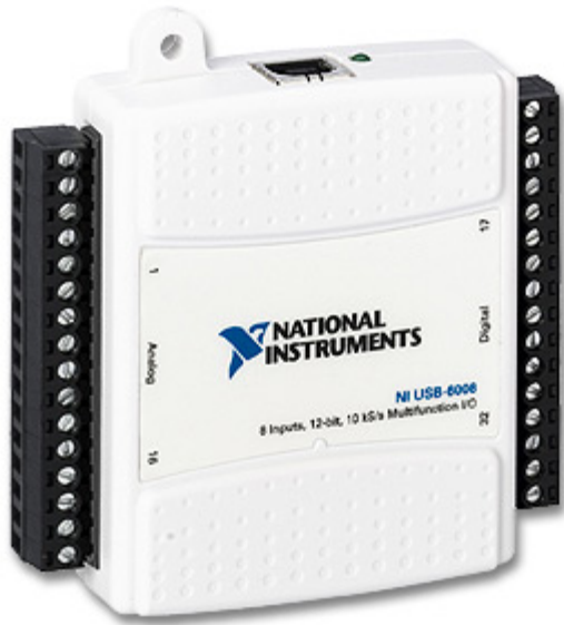
Εικ 1. ο controller NI USB-6008 της NATIONAL INSTRUMENT
