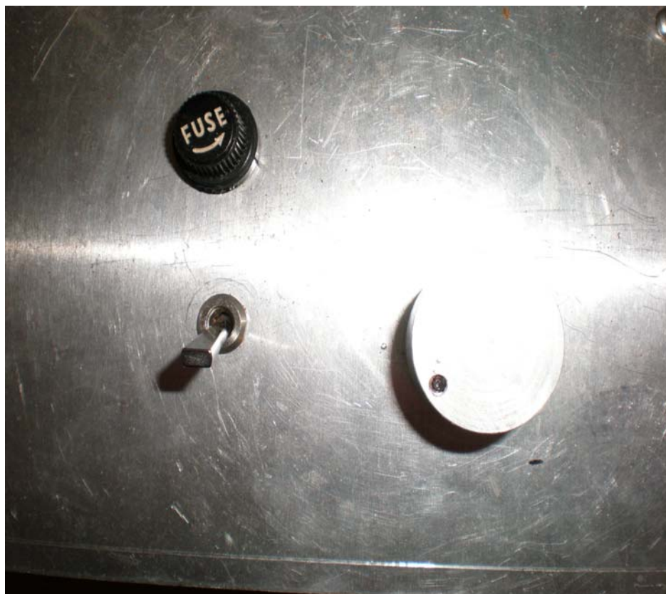
Εικ.16 Διακόπτης on-off και ρυθμιστής ταχύτητας(Ροοστάτης)
