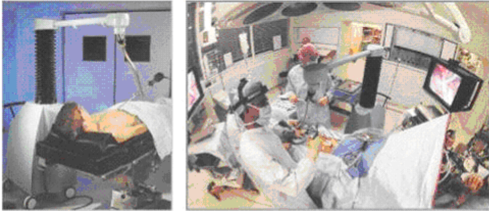
Εικόνα 25: Ρομποτικός Βραχίονας και Σύστημα Ανίχνευσης Κίνησης Προσαρμοσμένη στην Κεφαλή του Χειρουργού
