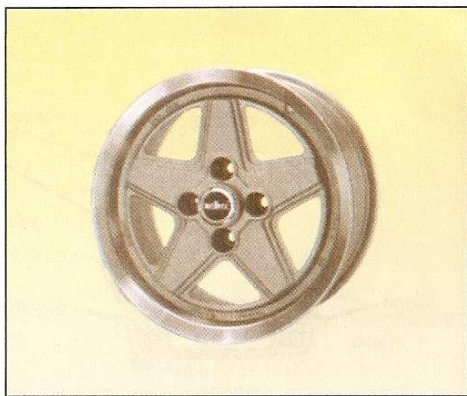
Σχ.5.34 Τροχός από χυτό αλουμίνιο
