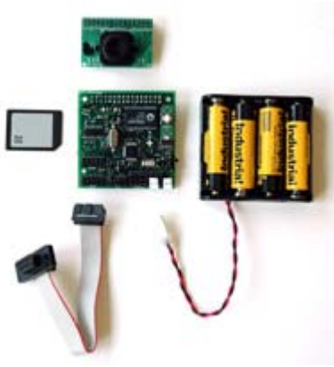
Εικόνα 24 Τα μέρη της CMUcam3 : αριστερά MMC/SD Flash card, επάνω μονάδα αισθητήρα-κάμερας πάνω σε CMOS της OmniVision ,μέση Ο κύριος επεξεργαστής είναι ο NXP LPC2106 , κάτω Σειριακό καλώδιο , δεξιά Τροφοδοσία
