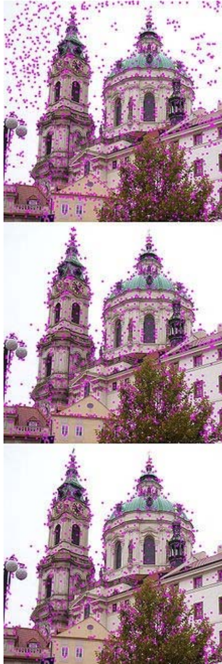
Εικόνα 17 Τα σημεία ενδιαφέροντος όπως αρχικά ανιχνεύονται από τον αλγόριθμο S.I.F.T. και καθώς αυτά απορρίπτονται διαδοχικά από τα βήματα του αλγορίθμου
