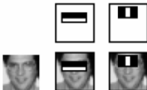
Εικόνα 27 Δείχνει τα δύο πρώτα χαρακτηριστικά που επιλεχθήκανε μέσω AdaBoost από τους Viola-Jones. Το πρώτο είναι το παράδειγμα που ανφέραμε παραπάνω (haar – γνώρισμα 2-ορθογωνίων) ενώ στο δεύτερο χρησιμοποιούνται οι περιοχές μύτης και ματιών σαν χαρακτηριστικό (haar – γνώρισμα 3-ορθογωνίων).
