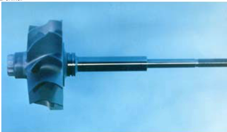
Εικόνα 8.5: Στην παραπάνω εικόνα απεικονίζεται η φτερωτή του στροβίλου.
