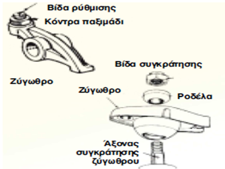
Σχήμα 5.16: στο παραπάνω σχήμα απεικονίζονται το ζύγωθρο και η βαλβίδα ρύθμισης.
