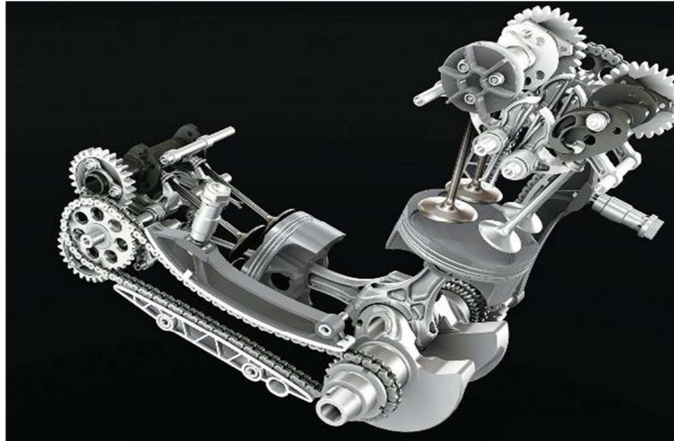
Εικόνα 5.17: στην παραπάνω εικόνα απεικονίζεται η μετάδοση της κίνησης του στροφαλοφόρου με του εκκεντροφόρου με τη χρήση αλυσίδας.
