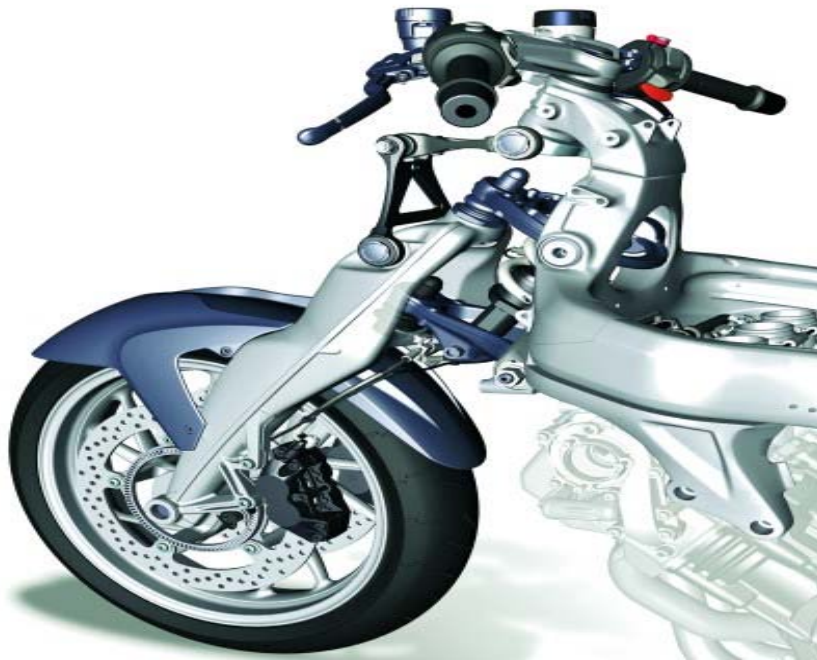
Εικόνα 5.1 ανάρτηση τύπου duolever 34
