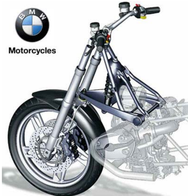
Εικόνα 5.2 Ανάρτηση τύπου telelever 35
