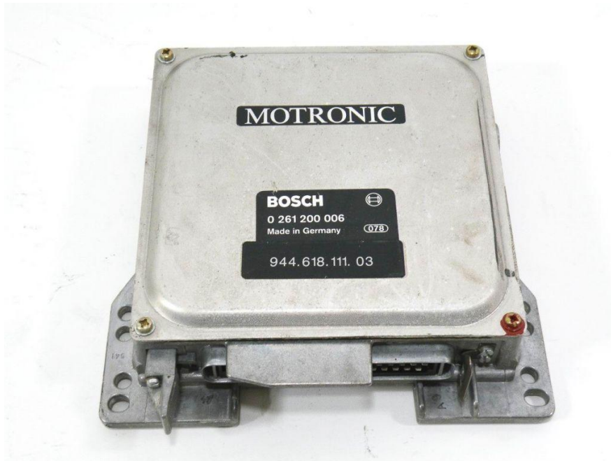
Εικόνα 44 Ηλεκτρική μονάδα ελέγχου
