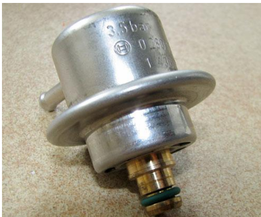
Εικόνα 16 Εξωτερική όψη του ρυθμιστή πίεσης καυσίμου όπου διακρίνονται οι συνδέσεις.
