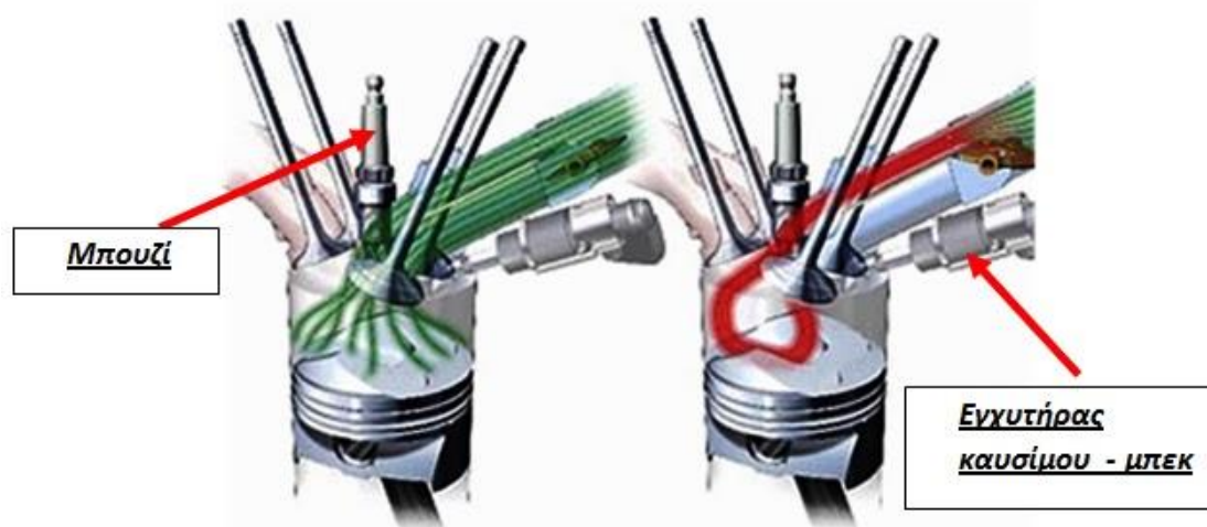
Εικόνα 39 Στη παραπάνω εικόνα διακρίνονται ο σπινθηριστής (μπουζί) και ο εγχυτήρας καυσίμου.
