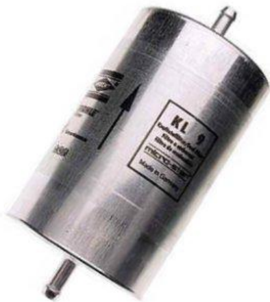
Εικόνα 26 Δείγμα φίλτρου καυσίμου για την συγκράτηση των αιρούμενων σωματιδίων που βρίσκονται μέσα στο καύσιμο.
