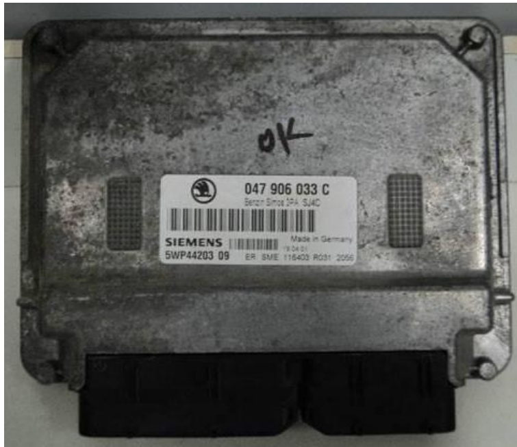
Εικόνα 21 Εγκέφαλος αυτοκινήτου για τον έλεγχο των λειτουργιών του.
