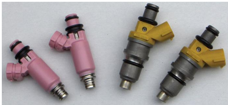
Εικόνα 17 Στην παραπάνω εικόνα φαίνονται τέσσερα παραδείγματα μπεκ ψεκασμού καυσίμου.
