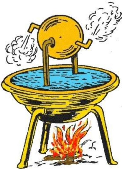
Εικόνα 1 Η πρώτη θερμική μηχανή με την ονομασία αιολικός κινητήρας του Ήρωνα.
