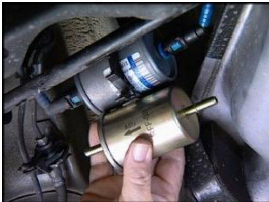
Εικόνα 14 Τοποθέτηση φίλτρου βενζίνης όπως φαίνεται από την κάτω πλευρά του οχήματος.
