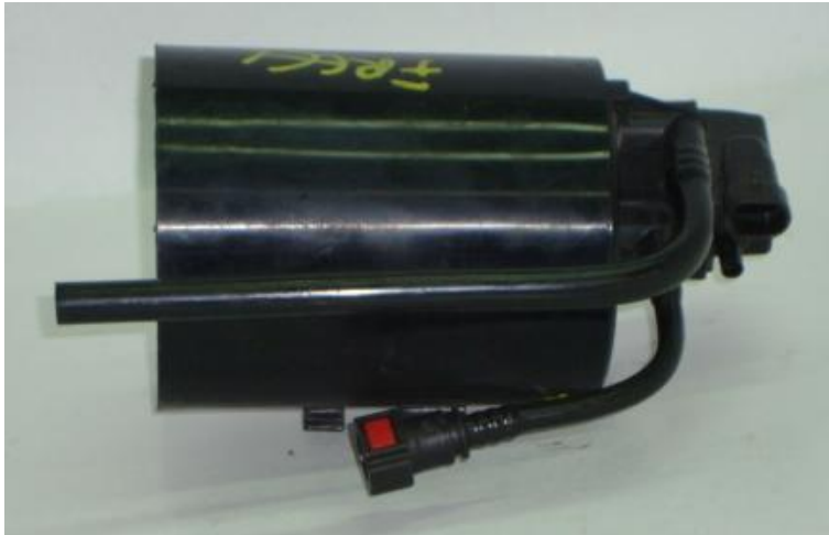
Εικόνα 29 Δοχείο ενεργού άνθρακα
