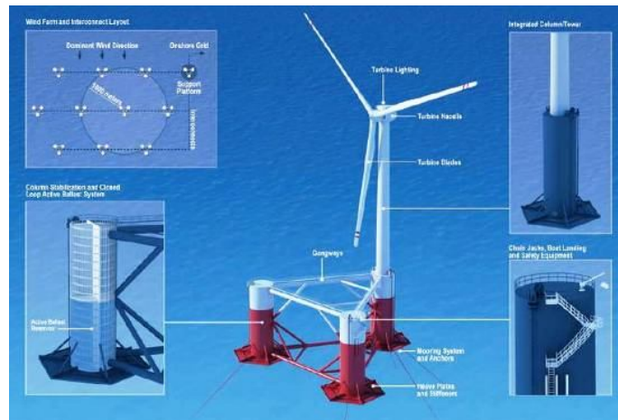
Εικόνα 13: Θεμελίωση τύπου windwave float
