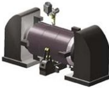
Εικόνα 19: Συναρμολόγηση των τμημάτων με τη μέθοδο Head and tail stock positioned. [4]
