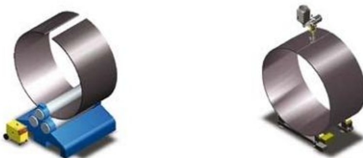
Εικόνα 18: δημιουργία του κελύφους. Πρώτον : Οι πλάκες κουρμπάρονται . Στη συνέχεια: Εξωτερικά και εσωτερικά διαμήκης ηλεκτροσυγκολλούνται δια της μεθόδου του arc welding
