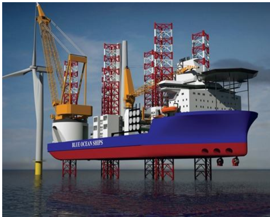
Εικόνα 27: Wind Turbine Installation Vessel (WTIV)
