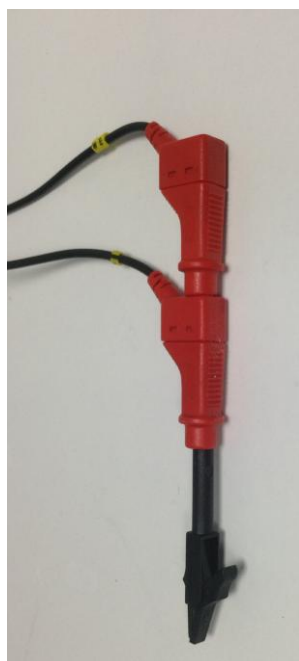
Εικόνα 2.5 Ηλεκτρόδιο εργασίας, το οποίο προμηθεύτηκε για τις ανάγκες των εργαστηριακών μετρήσεων από την εταιρεία Metrohm UK Ltd.
