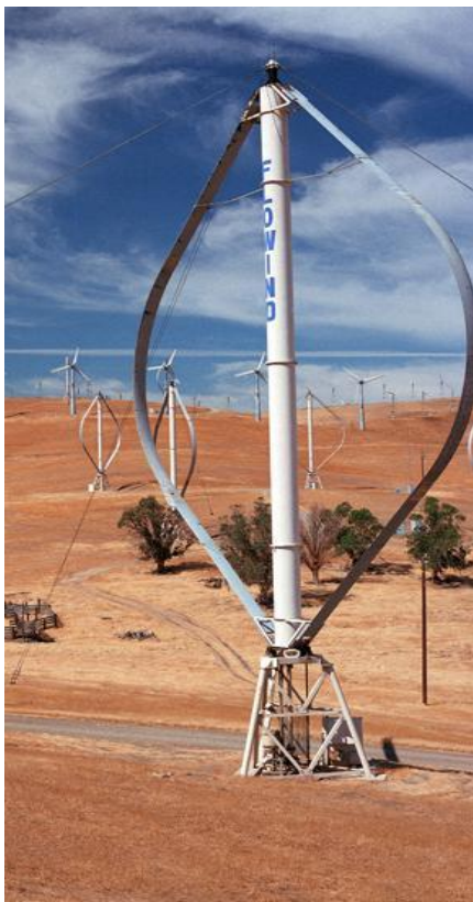
Α/Γ Κατακόρυφου Άξονα
